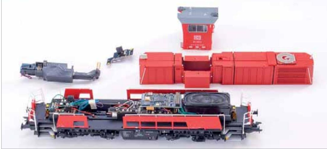
Kein Kubikmillimeter verschwendet: Das knappe Volumen unter den beiden Vorbauten ist vollgestopft mit moderner Elektronik, Lautsprecher und Raucherzeuger.
