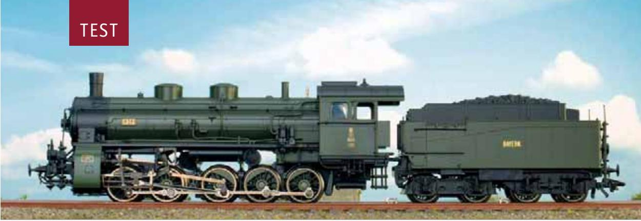
Das im Stehkessel versteckte Getriebe ermöglicht den großzügigen Durchblick über dem Barrenrahmen und die Sicht auf die Gleitbahnen des Hochdrucktriebwerks.
