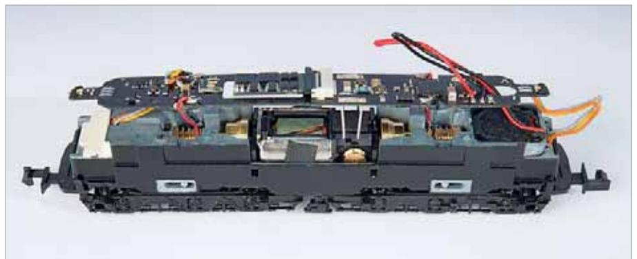
Wie aufwendig die Konstruktion eines Sound-Modells in N ist, verdeutlicht die Innenansicht der E50. Rechts sitzt der Lautsprecher, unterhalb der Schnittstelle der schrägenutete Motor.
