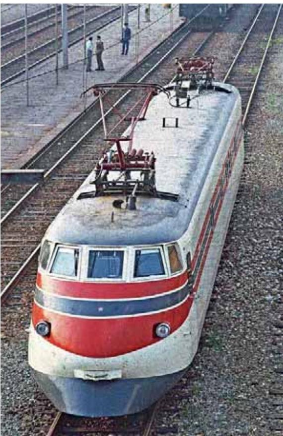
Solo-Triebwagen ETR Y0160 als Erprobungsträger für Gyroskop-basierte Fiat-Neigetech-
