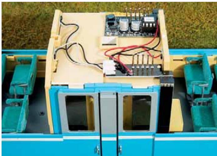
Eine sichere Verbindung zum abnehmbaren Gehäuseoberteil wird über Federkontakte hergestellt.
