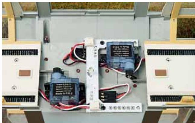
Unter dem Dach verbergen sich mittig die beiden Servoantriebe zum unabhängigen Heben und Senken der Stromabnehmer.
