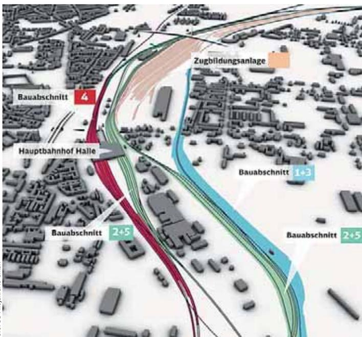
Zukunft farbig zusammengefasst: Ab 2015 wird zunächst die Osthälfte (grün) des Personenbahnhofs zurückgebaut und komplett saniert. 2016 folgt die Westhälfte (rot). Parallel läuft bereits der Neubau der Zugbildungsanlage (orange) mit den Zufahrtsgleisen. Viele interessante Informationen zum Bau gibt es hier: [www.vde8.de](http://www.vde8.de)
