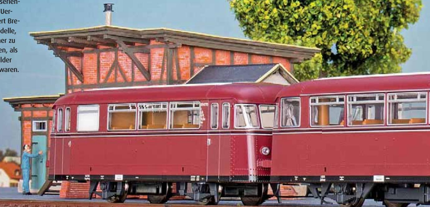
die Anzahl der Nietenköpfe ist korrekt, diese sind auch sehr fein ausgeführt. So finden sich auf den Dächern die Sicken in korrekter Zahl, an den Stirnseiten erkennt man die rautenförmigen Fabrikschilder und am Fahrzeugboden des Triebwagens sitzen die filigranen Fangbügel. Am Beiwagen fehlen diese, hatte er doch keine Steuerfunktion und lief folgerichtig immer am Zugschluss. Ein solcher Bügel liegt als Ersatzteil bei, sollte es einmal zum Bruch des empfindlichen Kunststoffteils kommen.
