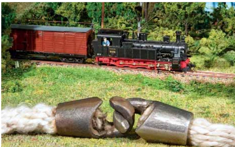
Was liegt denn da? Es sind zwei Verbindungshaken, so genannte Frösche, mit einem Stück Bremsseil. Das Geschenk der Döllnitzbahn wird bei Ausstellungen als Absperrung benutzt.
