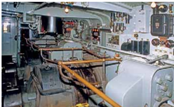
Der Maschinenraum mit asymmetrischer Konstruktion: links die Antriebsseite mit Durchgang und Fahrmotoren, rechts die Apparateseite.
