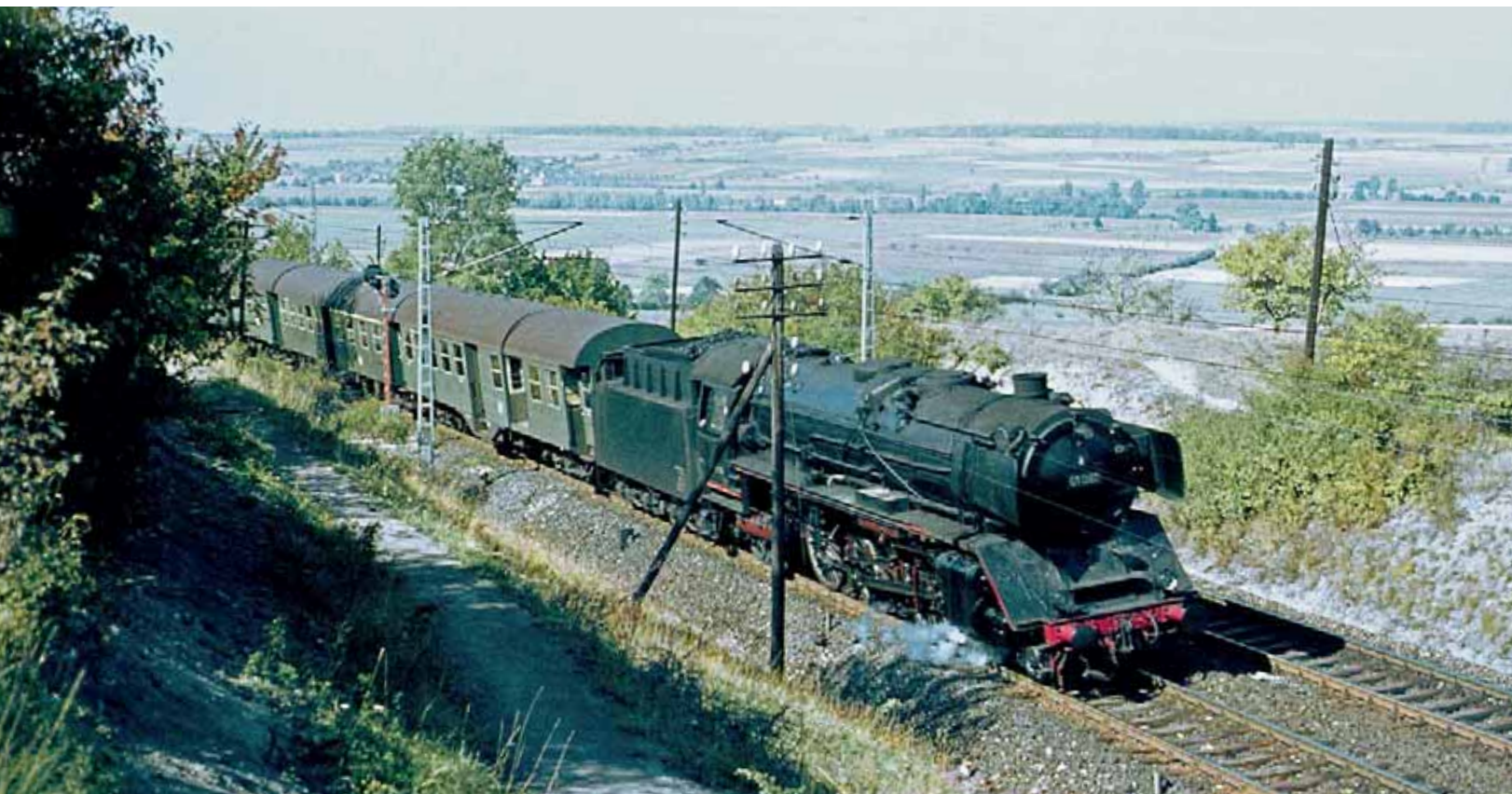
Auf Bergfahrt ist am 25. September 1964 der Personenzug 1362 mit 01080 in Burgbernheim eingefahren. Diese Lok gehörte zu den wenigen Exemplaren, die beidseitig auf dem Laufblech über dem Steuerungsträger einen großen quaderförmigen Kasten aufgewiesen haben.
