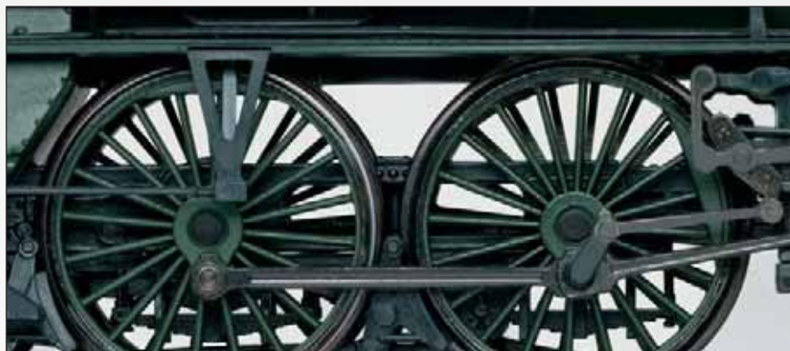
Filigranes Fahrwerk aus Metalldruckguss mit durchbrochenem Barrenrahmen und freier Fahrwerksdurchsicht
