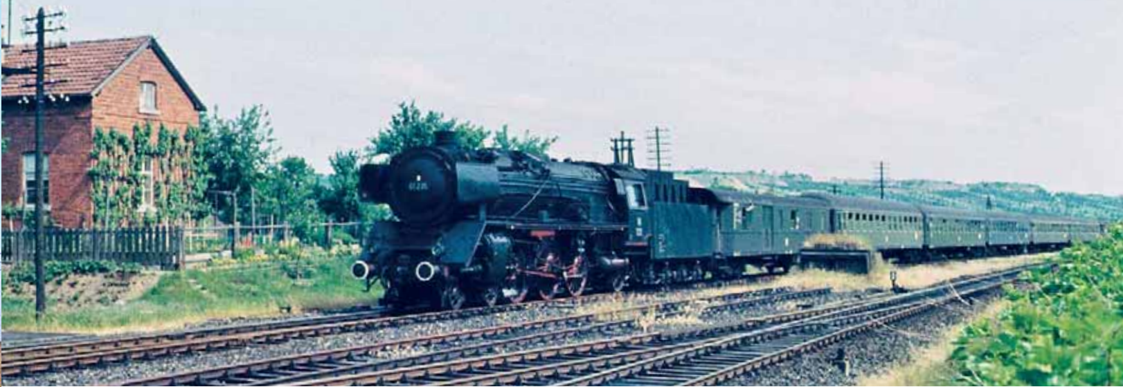
D 83 am 24. September 1958 in Winterhausen mit 01 235. Dies ist die ehemalige Vierzylinder-Verbund-Lok 02 010, die 1938 im AW Meiningen zur Zweizylinder-Lok umgebaut worden ist.
