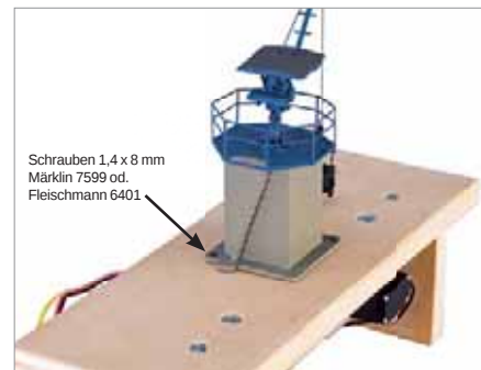
Das Montagebrett trägt die Verschraubungen für den Kransockel und die Servo-Winkel.
