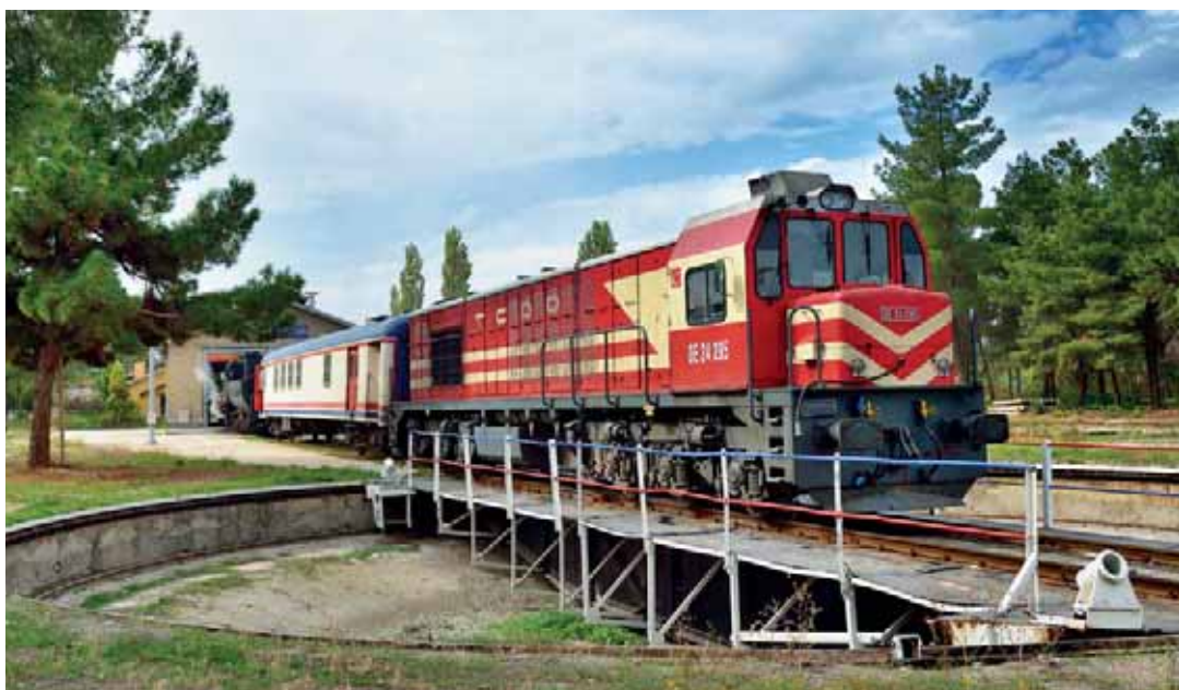
Die DE24295 ist ein türkischer Lizenzbau einer General-Electric-Konstruktion. Als Lokomotive des Begleitzuges steht sie am 16. Oktober 2014 auf der Handdrehscheibe in Burdur.
