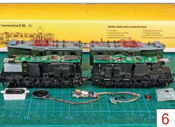
Wegen der zwei Lokhälften etwas komplizierter gestaltet sich der Umbau der E95.
