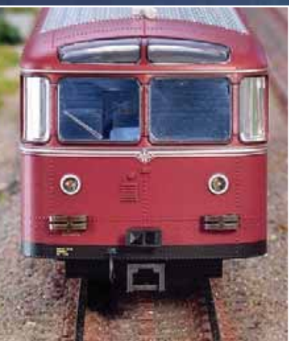
Typisch VT 95: Federbügel anstatt Puffern, zwei Oberlichtfenster in der Dachrundung und natürlich das Uerdinger Fabriksschild auf der silbernen Zierleiste.
