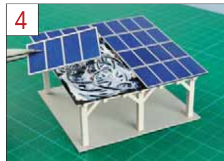
Das Aufkleben der Kollektoren sollte sauber im rechten Winkel erfolgen.
