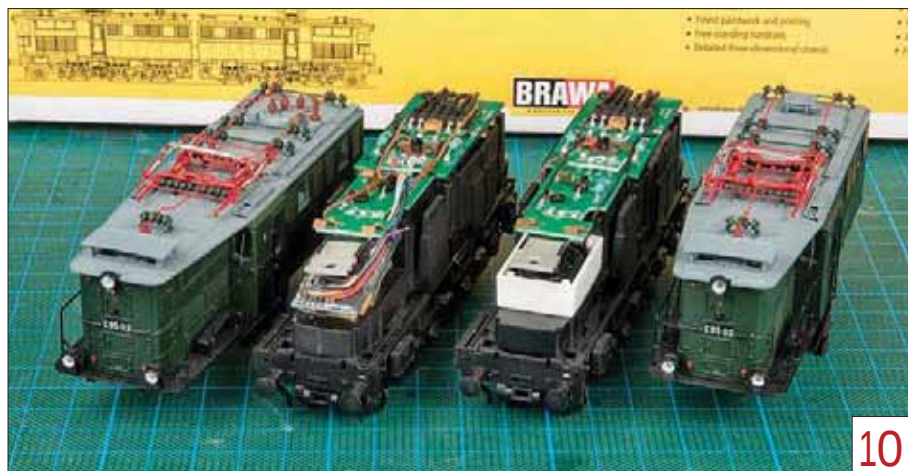
Beide Lokhälften sind nun mit Sounddecoder beziehungsweise Lautsprecher ausgestattet. Was noch fehlt, ist eine geschickte Lösung für die Kabelverbindung beider Komponenten.
