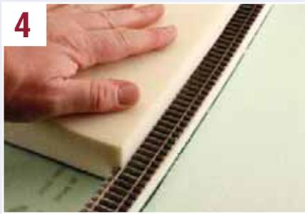
Das nahtlose Anpassen an den Trassenverlauf erfolgt durch mehrmaliges Entlangziehen des Modur-Schaumstoffes an der Schwellenkante des Innen- und Außenbogens.
