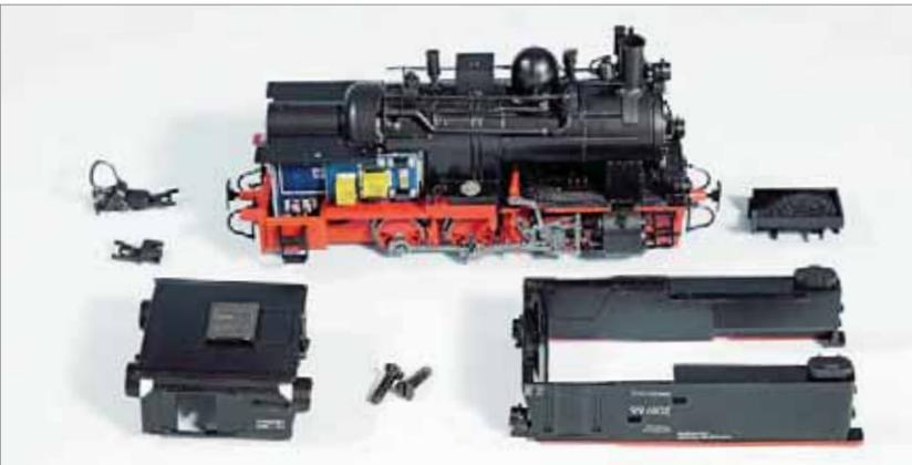
Die Schnittstelle wird nach Abnehmen von Kohlen- und Wasserkästen sowie des Führerhauses zugänglich. Vorsicht, Kleinteile können dabei leicht abbrechen!
