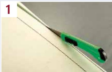
Der bogenförmige Verlauf der Strecke wird aus 20 Millimeter starkem Styrodur, im entsprechenden Radius angezeichnet, ausgeschnitten.
