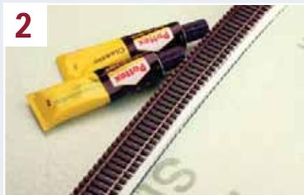
Das Verkleben des Tillig-Flex-Gleises erfolgt mit Pattex Classic. Für Styrodurflächen ist Pattex lösungsmittelfrei zu verwenden, beide Klebstoffe sind übrigens kompatibel.
