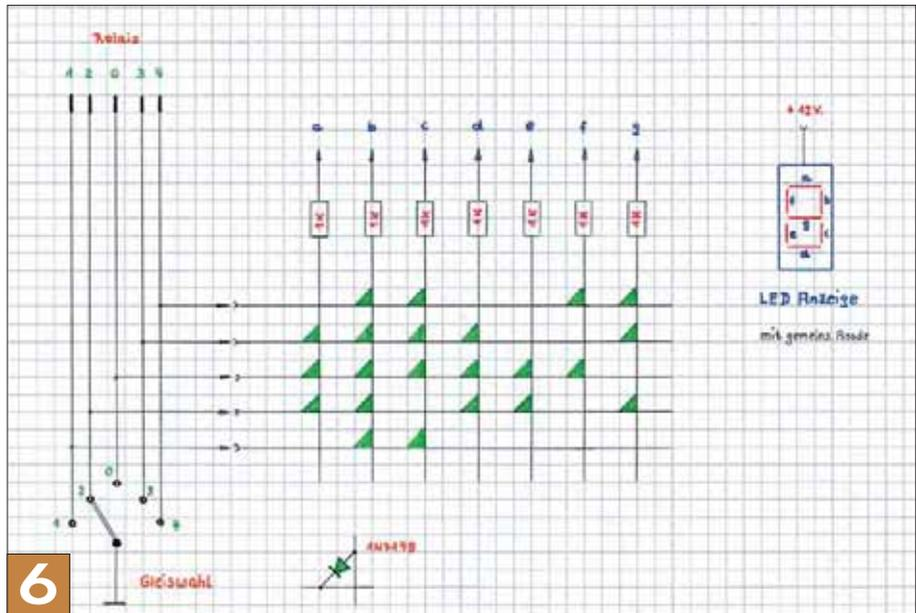
Für die einfache Version des Bedienteils genügt die Wahlschaltausstattung. Die deutlich komfortablere Variante schließt die siebensegmentige LED-Anzeige (rechts) mit ein.
