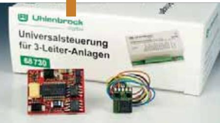
Zwei neue Decoder bietet Uhlenbrock an: Der 77100 (links im Bild) für H0-Loks mit hoher Stromaufnahme sowie kleinere Loks der größeren Baugrößen hat eine Dauerbelastbarkeit von 1,8 A. Der 73800 (rechts) ist ein kleiner
