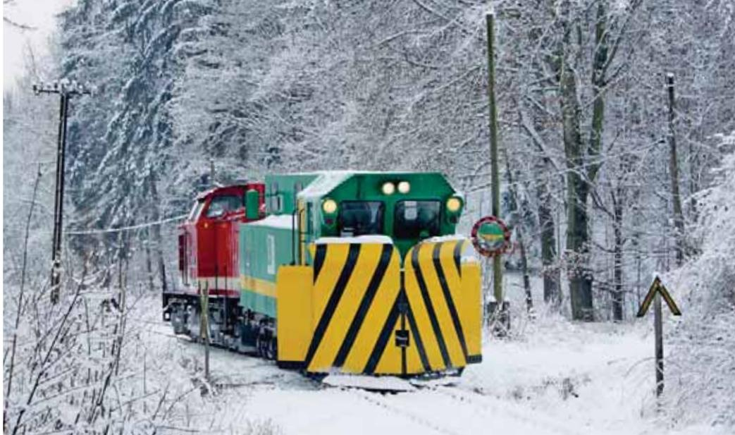
Das Foto eines Räumensatzes vom 8. Januar 2010, bei dem der Schneepflug an einem vereisten Überweg bei Siebenlehn entgleiste, zeigt neben dessen Schiefelage die ausgefahrenen Seitenpflugschare sowie die Lichtsignalanlage hinten rechts. Es schob die 112 708 der RISS.
