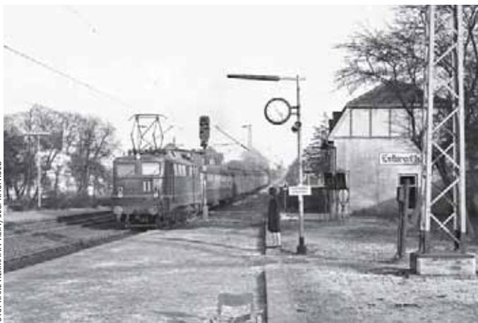
**E-Lok schiebt Dampflok:** Die E 40.11 mit Widerstandsbremse hilft im Jahr 1963 dem von 50 1456 gezogenen Personenzug über den Berg.
