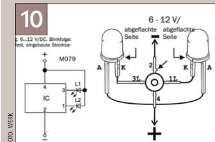
Die beiden LED des WÜ werden an ein Blinkmodul angeschlossen.
