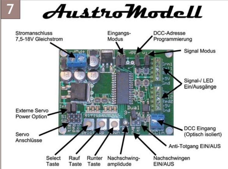
Das Steuermodul bietet zahlreiche Anschluss- und Steuerungsmöglichkeiten, sowohl in analoger als auch digitaler Funktion.
