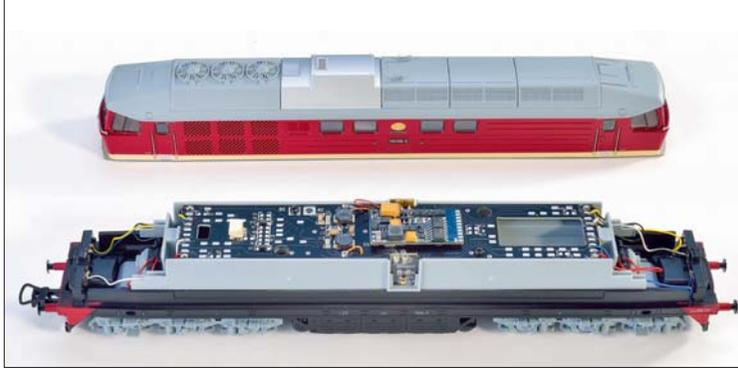
Nach Herausdrehen von zwei Schrauben kann das Gehäuse ab-
