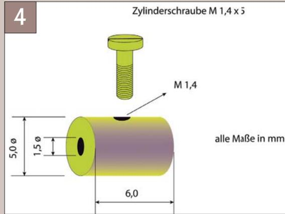
Um die Stellstange für den Servo-Antrieb greifbar zu machen, wird eine Messingmuffe mit Feststellschraube benötigt.
