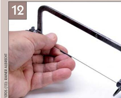
Mit einer Feinsäge wird eine Nut für die Kabelführung in die Masten eingelassen.
