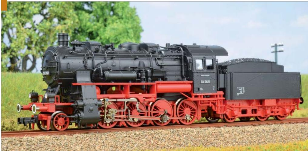
Epoche III mit neuer Betriebsnummer wiederaufgelegt. Im Tender sorgt ein Bühler-Motor für den Vortrieb, die Schnittstelle nach NEM 651 liegt etwas beengt im Kessel. Eine DCC-Digitalversion mit Sound ist ebenfalls lieferbar.
