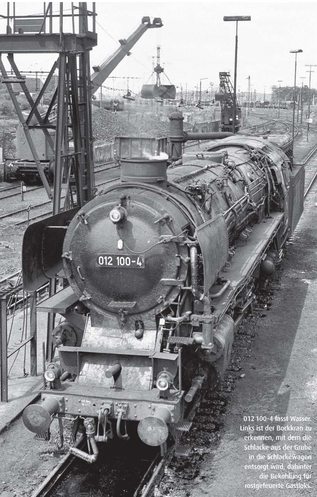
012 100-4 fasst Wasser. Links ist der Bockkran zu erkennen, mit dem die Schlacke aus der Grube in die Schlackewagen entsorgt wird, dahinter die Bekohlung für rostgefeuerte Gastloks.
