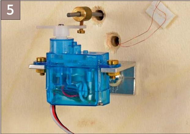
Der Micro-Servo von Austromodell benötigt nur wenig Platz und wird direkt mit der Muffe an der Stellstange verbunden.
