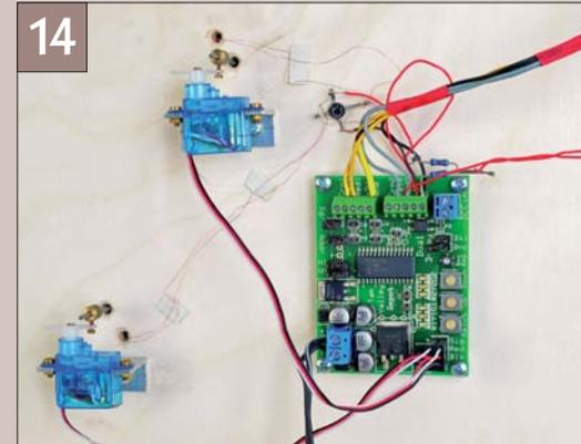
Die Verdrahtung für den Test wurde freischwebend ausgeführt. Für den Anlageneinsatz sollte man feste Lötstützpunkte verwenden.
