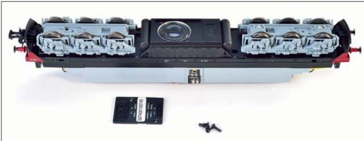
Im Tank der Lokomotive kann der etwa 20 mm große Lautsprecher untergebracht werden.
