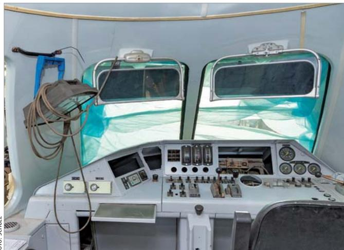
Ein Blick in den Führerstand des ET403: Nach einer intensiven Inspektion der Fahrzeuge ist inzwischen sicher, dass die ET403 unter anderem komplett neu verkabelt werden müssen. An der Aufarbeitung des elektrischen Teils ist auch der Fahrzeughersteller Bombardier beteiligt.
