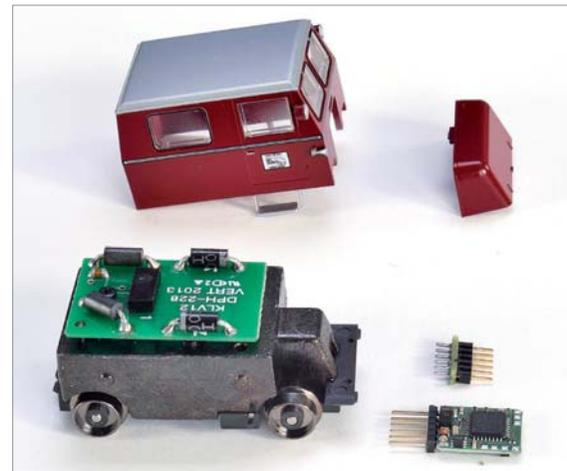
des Fahrwerks ist allerdings eher einfach ausgefallen und lässt einige Details vermissen. Die KLV werden ab Werk mit DCC-Decoder ausgeliefert, lassen sich damit aber auch analog betreiben. Die Digital-Fahreigenschaften sind ausgewogen, allerdings müssen die Gleise sehr sauber sein.  abp
