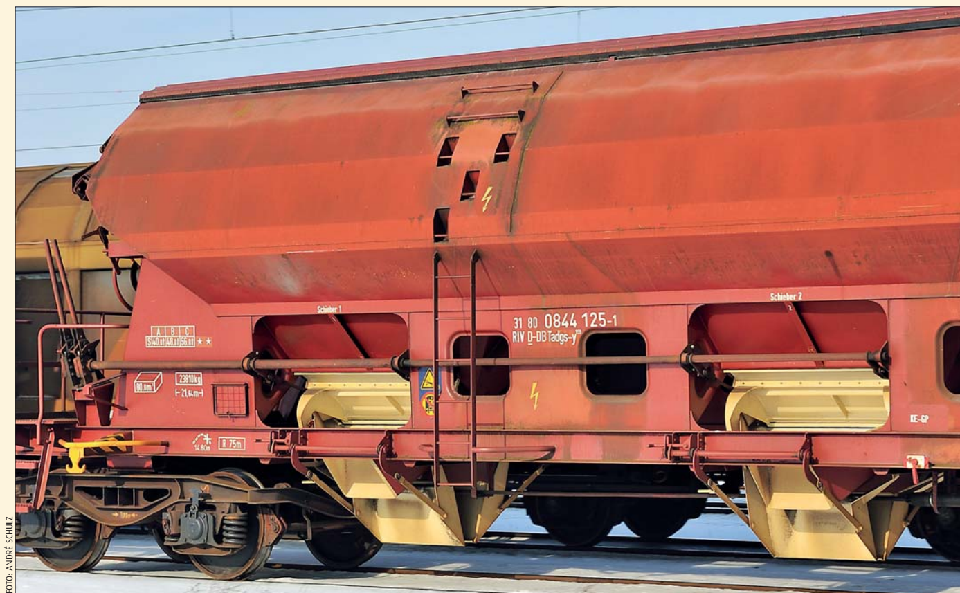
Winter 2010 in Saarmund: Bestes Licht, um alle Einzelheiten des frisch untersuchten Tdgs-y959 ins Bild zu setzen. Man beachte die hell gestrichenen Auslauföffnungen und die Zierlichkeit des Y25-Drehgestells, an die viele Modellbahnhersteller mit ihren Nachbildungen nicht ganz herankommen.
