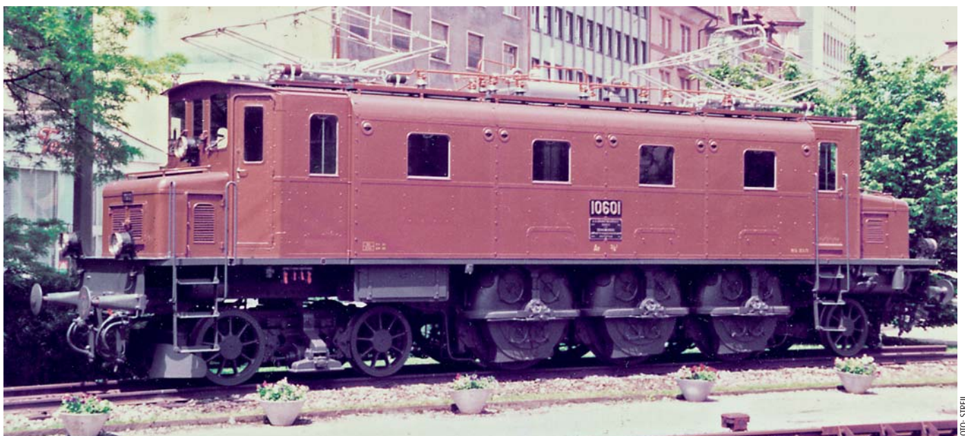
Ae 3/6 I, SBB-Nr. 10301, spätere 10601 mit dem von Jakob Buchli konstruierten Gelenkhebel-Einzelachs-antrieb: Als erste Maschine einer Serie von 114 Lokomotiven stand sie zum Zeitpunkt der Aufnahme als Denkmal vor ihrem Herstellerwerk BBC im Schweizer Bahnhof Baden.
