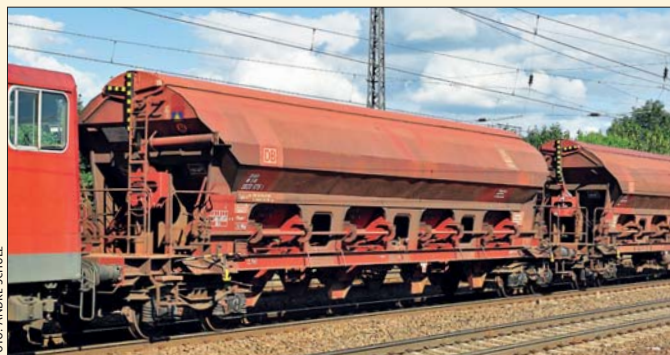
Nicht mehr für Getreide: Nach Abnutzung der Innenbeschichtung entfiel das „g“ in der Gattungsbezeichnung, nun also Tads-y 958, Saarmund 2010.
