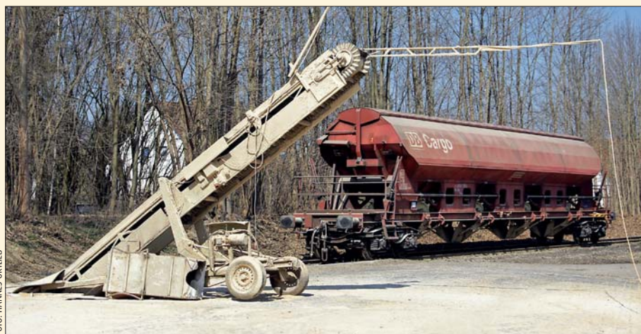
Offensichtlich für Getreide: Ein Tadgs 959 der DBAG wartet 2012 in Pfaffenhofen/Ilm auf die Beladung. Vom Traktor-Anhänger gelangen die Körner mittels Förderbands in den geräumigen Laderaum.
