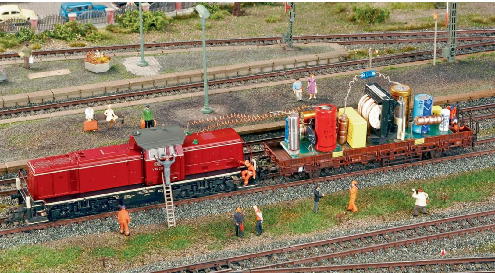
Mit Hilfe von Pufferkondensatoren erhalten Loks wie die V 90 von Märklin im Bedarfsfall Strom zur unterbrechungsfreien Fahrt.
