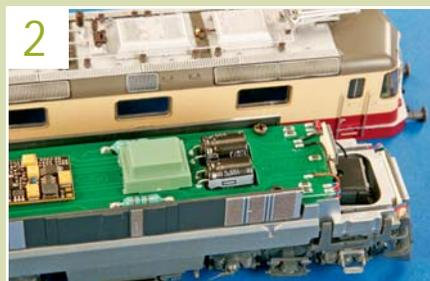
Auch die Fahrzeug-Hersteller haben die Vorzüge der Pufferkondensatoren entdeckt. Fallweise sind diese wie hier bei einer Roco-Lok bereits werkseitig eingebaut.
