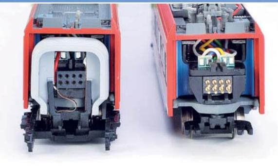
Der Zug ist durchgehend elektrisch verbunden. Der Käufer erhält den 440 zweigeteilt und muss ihn in der Mitte zusammenstecken.
