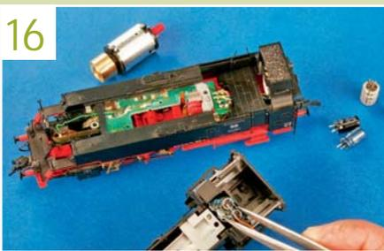
Der Raum in Tenderloks ist meist sehr begrenzt. Geeignete Stellen zum Speicher-Einbau sind Wasserkästen, Feuerbüchse, Kessel oder Führerhaus-Dach.
