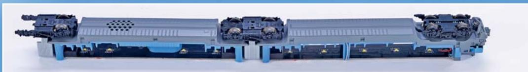
Die Schalllöcher links zeigen an, dass der Piko-Lirex bereits für einen Soundbaustein vorbereitet ist.
