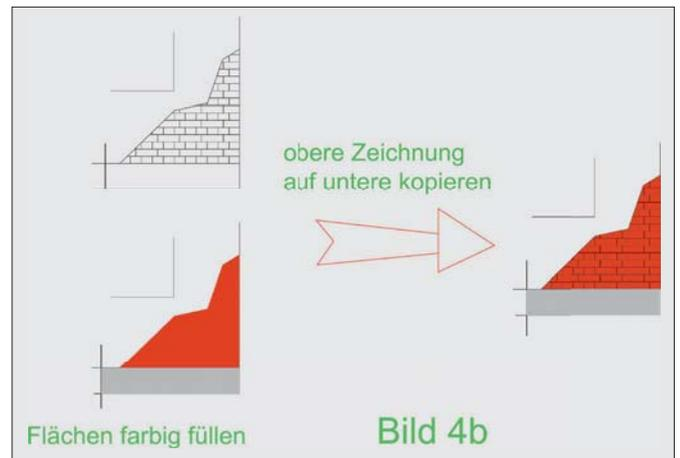
**Layertechnik:** Die Strichzeichnungen, hier der Einfachheit halber auf eine Mauerecke beschränkt, mit Wandumriss, horizontalen und vertikalen Mörtelfugen werden nach Abschluss der Farbgestaltung der zu füllenden Flächen auf Basis der Umrissangaben auf diese Farbzeichnung kopiert.
