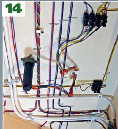
Und wieder zahlt sich die saubere Verkabelung aus: Signal N1 wurde einfach an die vorbereiteten Lüsterklemmen angeschlossen. Von unten erfolgte auch die mechanische Fixierung: Der Spreizklemmen-Befestigungsring am Antrieb erlaubt stets problemlosen Ausbau.
