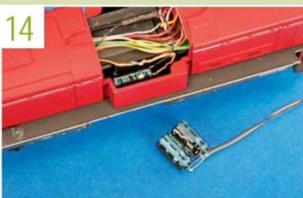
Auch im Führerhaus finden noch mehrere zusammengeschaltete Kondensatoren kleinerer Bauart Platz. Sound-Modelle entwickeln einen beachtlichen Appetit auf Strom.
