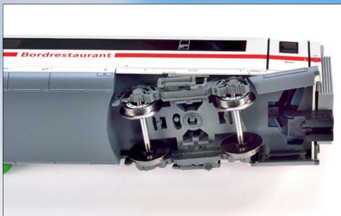
Das ausschwenkende Drehgestell würde die Verkleidungen in engeren Radien berühren und zur Entgleisung führen.
