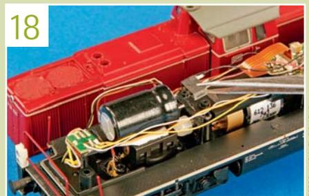
Mit dem eingebauten Speicher ist ein Programmieren des Decoders meist nicht möglich. Ein Miniatur-Schalter oder eine Steckbuchse unterbrechen den Anschluss.
