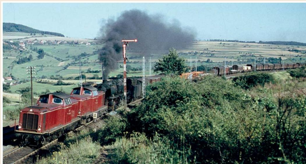
In der selben Kurve leisten am 30 August 1962 V 100 2004 und 2015 Vorspann vor Öl-44 1364. Der aufwendige Betrieb war zur Verringerung der Abgasbelastung in den Tunnelbaustellen nötig.
