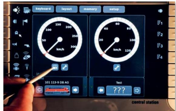
Bei Annäherung an eine virtuelle Füllstation erscheint ein kleines Zapfsäulensymbol. Die angezeigte Tacho-Geschwindigkeit kann auf die gemessene Modellgeschwindigkeit abgestimmt werden.
