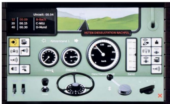
Der Diesellok-Führerstand im klassischen Grün älterer Bauarten: Der Dieseltank ist leer und eine Warnmeldung erscheint. Man kann per Touchpad oder wie bisher mit den beiden Drehknöpfen steuern.
