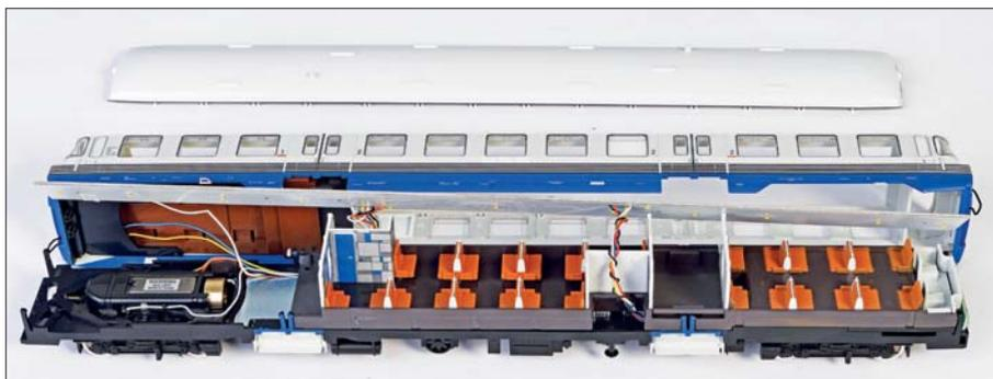
Elektronik und Antrieb mit Schwungmasse sind unauffällig untergebracht. Der in den äußeren Abteilen leicht angehobene Boden war dabei ein unumgänglicher Kompromiss.
