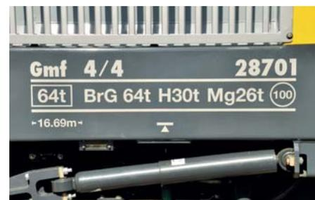
Das „G“ steht für eine Schmalspurlok, das „m“ für den Dieselantrieb und das „f“ für Funkfernsteuerung.
