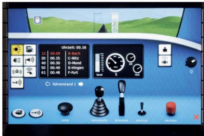
Warmmeldung, der Sicherheitsfahrshalter (Sifa) gedrückt werden, um Zwangsbremssungen nach dem Einschlafen des Lokführers vorzubeugen. Der Anschluss eines Lautsprechers ist sehr zu empfehlen, da man ansonsten fast ständig auf den Bildschirm starren muss, um die nächste Sifa-Warnung nicht zu verpassen.
