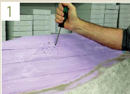
**1** Für die gute Verzahnung zwischen Gips und Styrodur werden mit einem Schraubendreher Löcher gestochen.
