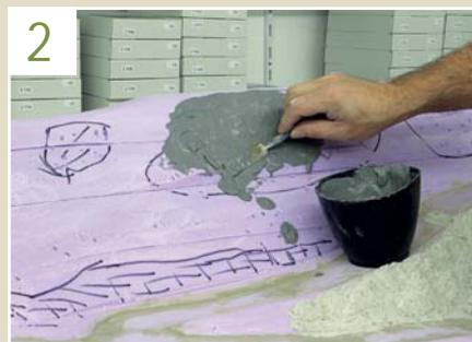
**2** Die erste dünnflüssige Gipsschicht sorgt für den Halt. Sie muss auch in die Schraubendreher-Löcher fließen.
