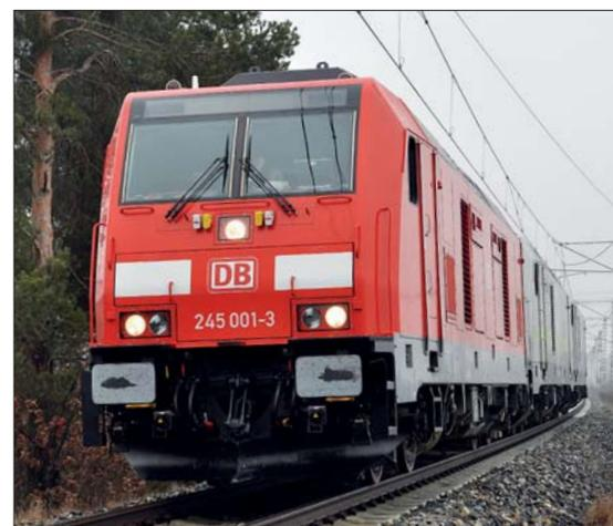
Vier Dieselmotoren, die nach Bedarf zu- oder abgeschaltet werden, kennzeichnen das neue Antriebskonzept der Baureihe 245.
