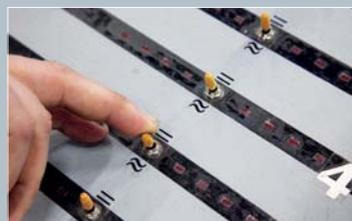
Per Kippschalter kann wahlweise der Fahrbetrieb auf Gleich- oder Wechselstrom umgestellt werden.
