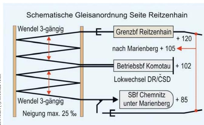
Die schematische Darstellung zeigt die Höhenunterschiede der einzelnen Ebenen sowie deren Streckenanbindung untereinander.
