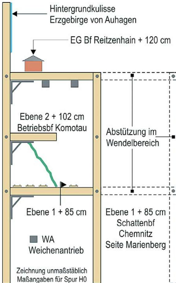
Vereinfachte Schnittdarstellung des Unterbaues der Anlagenseite Reitzenhain: Die Metallwinkel an den Wandstützen sorgen für die erforderliche sichere Auflage der waagerechten Platten.
