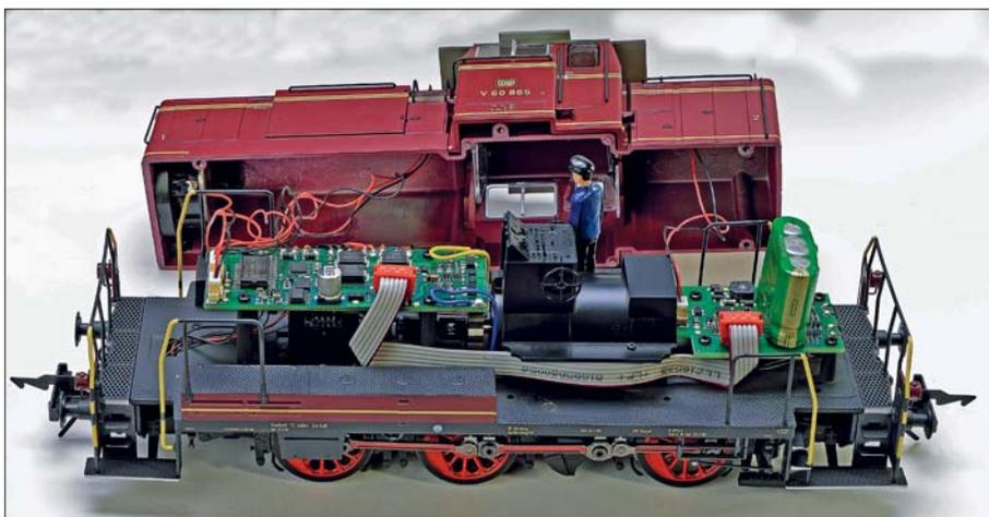
Reichlich Elektronik verbringt sich im Inneren. Aber selbst in einer V60 ist in Spurweite 0 genug Platz vorhanden, sowohl für einen Lautsprecher wie auch für einen dicken Speicherkondensator.
