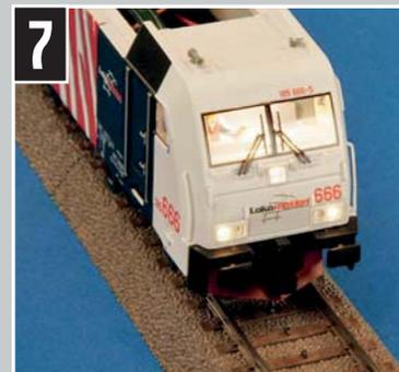
Unsere 185 hat eine schaltbare Führerstandsbeleuchtung erhalten, deren Helligkeit noch eingestellt wird. Die Frontbeleuchtung wurde auf warmweiße LED umgerüstet.
