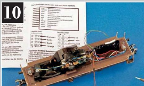
Die für Märklinisten ungewohnten Kabelfarben nach DCC-Norm werden in der Anleitung des Sets erklärt. Die Kabelverlegung im Getriebebereich sollte mit besonderer Sorgfalt geschehen.
