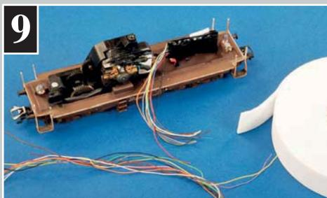
Für die Fixierung des neuen Decoders genügt etwas Doppelklebeband. Die Decoderkabel werden zunächst auf das längste benötigte Maß gebracht.
