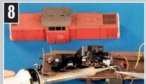
Bei Altfahrzeugen wie dieser 212 heißt es zunächst: Alles muss raus! Wichtig ist die einwandfreie mechanische Funktion des Modells, der Antrieb sollte genau geprüft werden.
