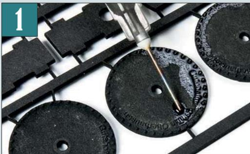
1 Mit dem flüssigen Sekundenkleber härtet man die empfindlichen Kartonteile durch Auftrüpfeln.
