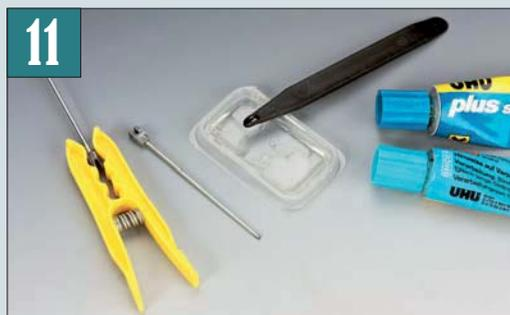
An einem Ende der Kolbenstange werden zwei Lagerschalen aufgeklebt. Ein Zweikomponentenkleber sorgt für den nötigen Halt des blanken Metallteils.
