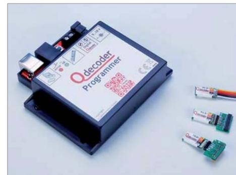
Mit dem Qdecoder-Programmer steht eine einfache Konfigurationsumgebung zur Verfügung.
