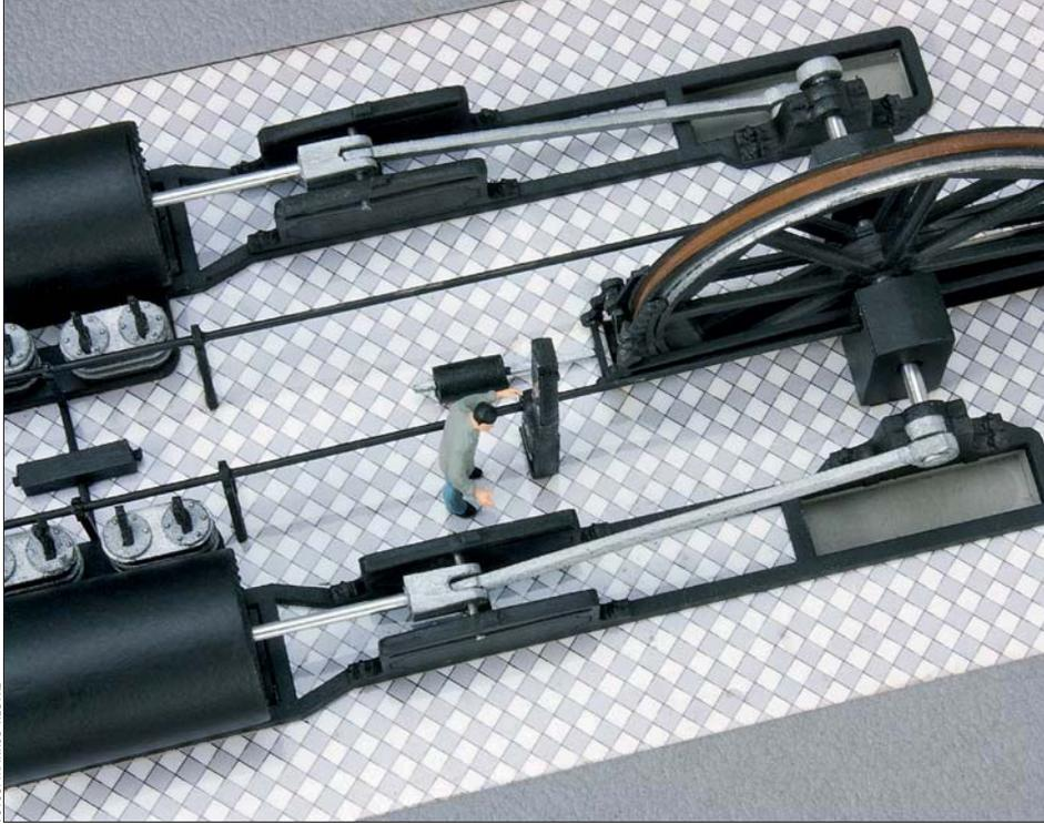
Mit einem Gummiband lässt sich motorisch das große Treibrad drehen, das über die festgeklebte Achse die Kolben horizontal in den Gleitlagern hin und her bewegt. Ein Teufmesser rundet das Modell ab.
