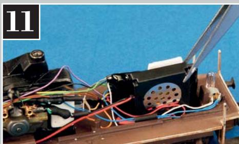
Für den Lautsprecher findet sich ausreichend Platz im geräumigen Vorbau der 212. Auch dieses Bauteil wird einfach mit Doppelklebeband befestigt.
