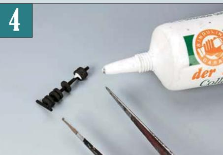
Der Zylinder der Bremsenrichtung für das Treibrad setzt sich aus mehreren runden Scheiben auf dem Kolbenrohr zusammen.
