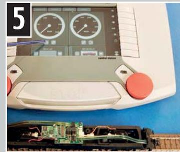
Nach dem Einsetzen des MSD-Decoders steht die Lok schon für eine Probefahrt bereit. Als Mfx-Fahrzeug meldet sie sich selbstständig bei der Zentrale an, ein passendes Bild lässt sich auch einfügen.
