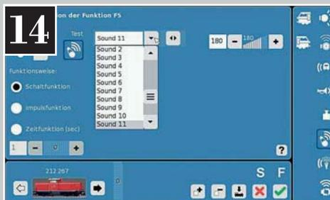
Die Konfiguration der einzelnen Funktionen (Funktions-Mapping) ist auf der CS 2 sehr übersichtlich dargestellt. Passende Symbole und die Lautstärke lassen sich einfach auswählen.
