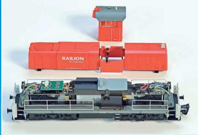
Mit nur wenigen Handgriffen lässt sich das Modellgehäuse, beispielsweise zum Decodereinbau, leicht demontieren.
