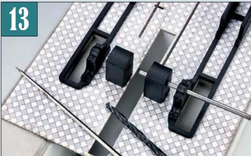
Damit die Achse in den Löchern der Getriebekästen und Lagern klemmfrei rundläuft, weitet man die Löcher mit einer Reibahle und einem 2,6-mm-Bohrer.
