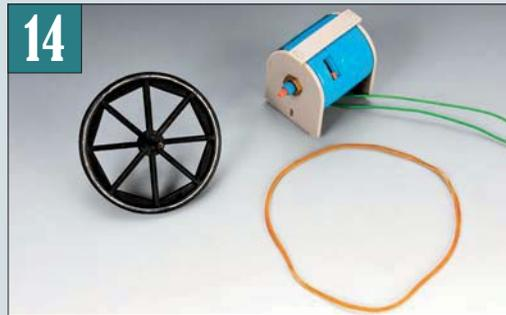
Wer mag, kann das große Treibrad mit einem Motor bewegen. Ein bräunliches Gummiband sorgt für genügend Spannung, um das Rad zu bewegen.
