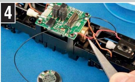
Nach dem Einsetzen der neuen Schnittstellen-Platine folgt der Einbau des Lautsprechers. Die recht dicken Original-Kabel sollte man gleich durch schwarze Decoderlitze ersetzen.
