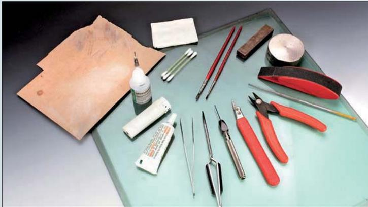
Für den Bau von Kartonmodellen benötigt man nur eine kleine Anzahl von Werkzeugen sowie Sekundenkleber und einen hochwertigen Weißleim. Eine Glasplatte als Untergrund sorgt für eine plane Auflage bei der Montage und lässt sich einfach reinigen.
