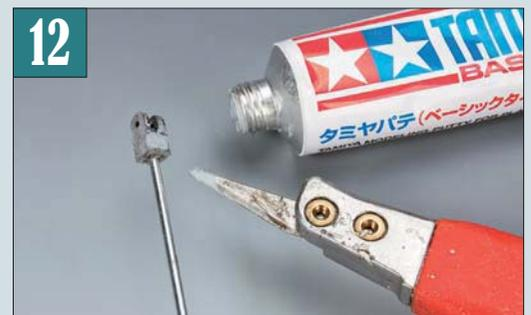
Den deutlich sichtbaren Spalt zwischen beiden Schalen sollte man mit Nitrospachtel verschließen und anschließend sauber und glatt verschleifen.
