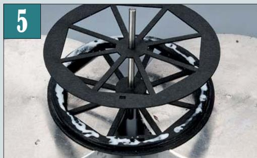
Das Treibrad setzt sich aus sechs großen Rädern und zwei Kleinscheiben zusammen. Es wird schichtweise geklebt. Die Achse dient als Montagehilfe.
