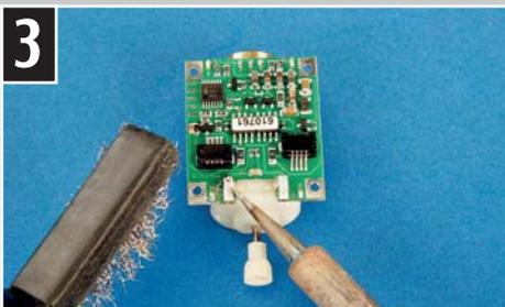
Von der alten Platine muss der Motor abgelötet werden. Wenn keine Entlötpumpe oder -litze zur Hand ist, kann man das Lötzinn auch mit einer Drahtbürste entfernen.
