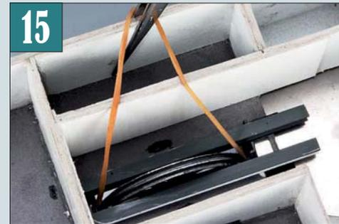
Beim Einfädeln der beidseitigen Bremsanlage von unten wird das störende Gummiband seitlich auf Spannung gehalten.
