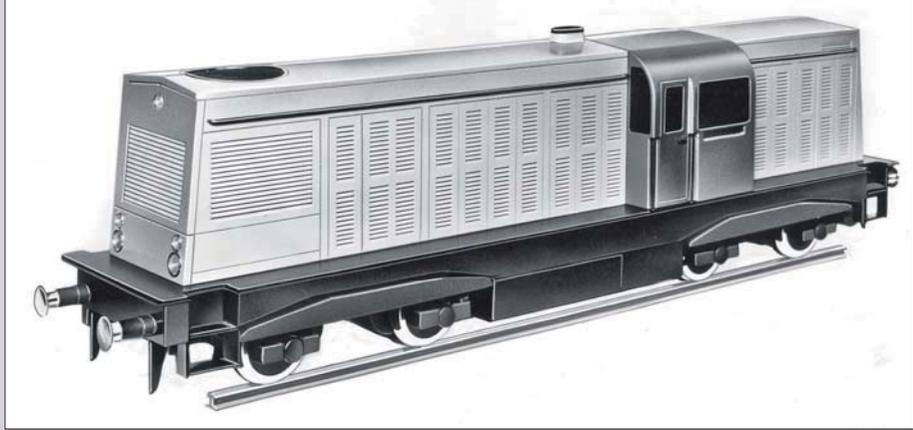
Vor der Realisierung der DE-Lokomotiven wurde diese Design-Studie angefertigt. Alle drei Lok-Typen besaßen die Radsatzfolge Bo'Bo, fuhren aber auf zwei unterschiedlichen Spurweiten.
