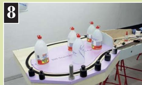
Die zugeschnittenen Styrodur-Stücke werden auf das Sperrholz geklebt. Wichtig ist, sie während des Aushärtens des Klebers zu beschweren.
