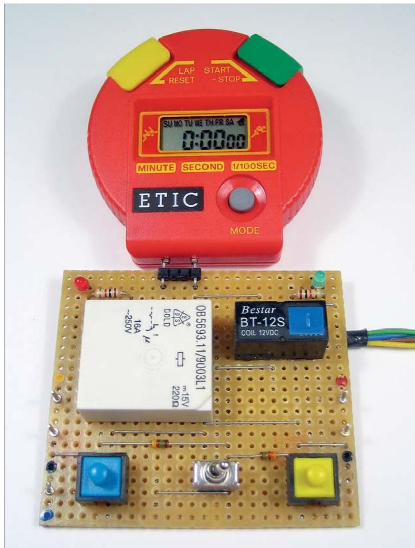
Das Eigenbau-Messgerät, bestehend aus umgebauter Stoppuhr und bestückter Lochrasterplatine, auf einen Blick: Alle Bauteile sind handelsübliche Erzeugnisse; das hier nicht zu übersehende bistabile Stromstoßrelais ist freilich nicht überall erhältlich.
