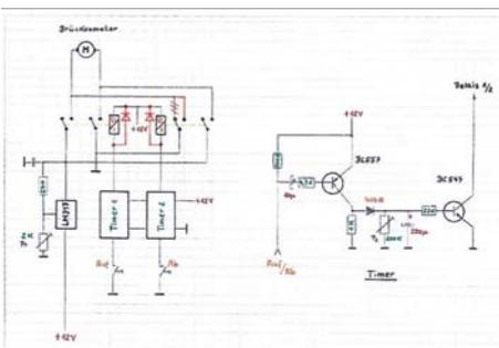
Korrigierter Schaltplan mit dem korrekt beschalteten Relais 2: So kann kein Kurzschluss mehr entstehen, sobald der Modellbauer den Taster „Auf“ betätigt.
