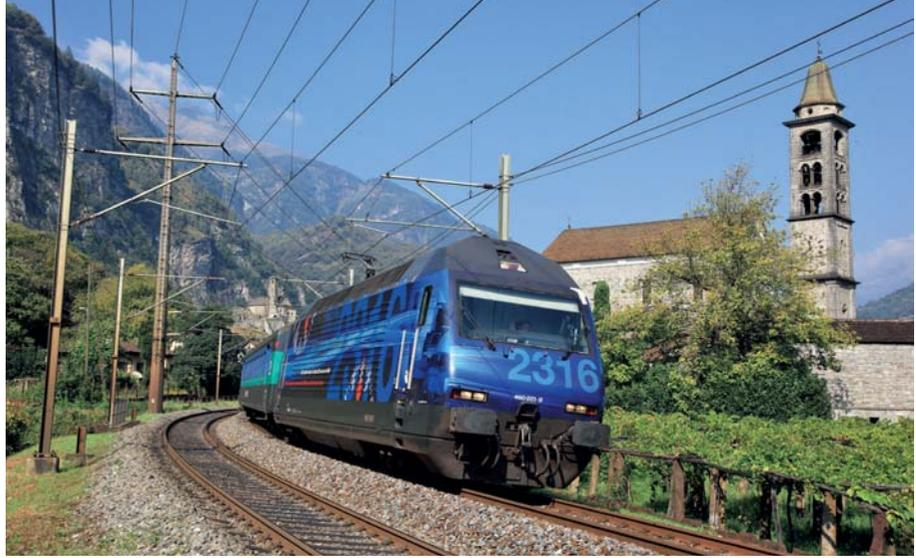
Zürcher S-Bahn weiterentwickelt und all die Erfahrungen mündeten in die Baureihe Re 4/4 460, wie sie anfangs hieß, von der die SBB ab 1987 in mehreren Losen 119 Stück bei SLM/ABB bestellte, ohne dass es einen Prototyp gab. Später schloss sich auch die Lötschbergbahn an, die eine äußerlich kaum unterscheidbare Type mit einigen maßgeblichen Veränderungen bei den inneren Werten nachbestellte.
