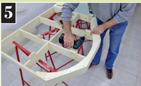
Die Schienen-Trasse konnte nun mit entsprechend zugeschnittenen Holzstücken sauber aufgeständert werden.
