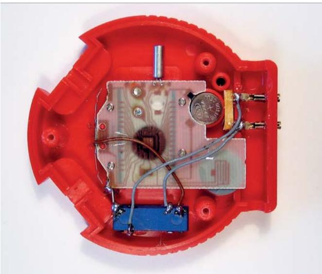
Das umgebaute Stoppuhr-Innenleben: Die beiden Spulenanschlüsse des eingeklebten Relais sind nach außen geführt, die beiden Schließkontakte angelötet.
