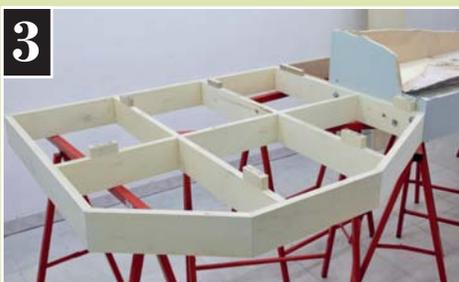
Die neuen Kopfstücke sind 90 Zentimeter tief und 100 Zentimeter breit und schließen direkt am alten Anlagenteil an.
