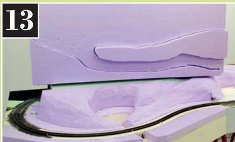
**13** Die Straßenkonturen werden extern mit einem Heißdrahtschneider aus einer Styrodurplatte ausgeschnitten.
