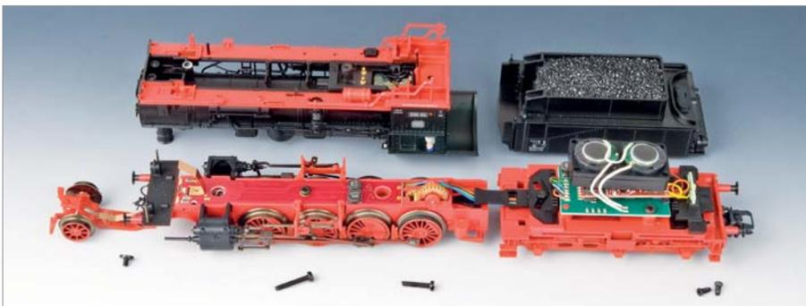
Nach dem leicht zu bewerkstelligen Öffnen verbleibt der Motor samt reichlich gefetteter erster Getriebestufe im Stehkessel. Im Tender liegen Decoder und Lautsprecher übereinander.
