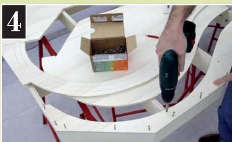
Nachdem die Gleislage festgelegt war, kam die Stichsäge zum Einsatz. Die einzelnen Trassenbauteile werden verleimt und verschraubt.
