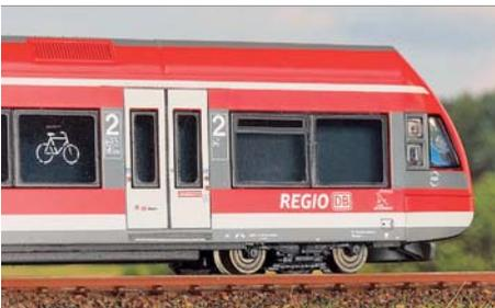
Angetrieben wird der Triebwagen über beide Enddrehgestelle, genau entgegengesetzt zum Antriebskonzept des Vorbilds.
