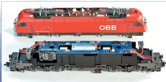
Gut zu erkennen ist der mittig eingebaute Motor mit den beiden Messingschwungmassen.
