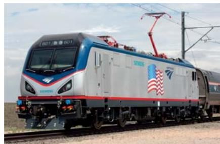
Siemens-Lok mit Fremd-Stromabnehmer: ACS 64 (Vectron Amerika-Version) im Juli 2013; der hochreichende Einholm für den US-Nordost-Korridor ohne Kuppelstrebe (mit Kettenradantrieb im Kniegelenk) stammt vom britischen Hersteller Brecknell-Willis.
