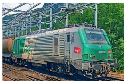
Prima BB 37000 der SNCF mit Faiveley-Einholm AX unter starrer Stromschienen-Oberleitung am 27. Juli 2017 in der Abzweigstelle Longera (Strecke Genf-Bellegarde, 2014 umgestellt von DC auf 25 kV AC).
