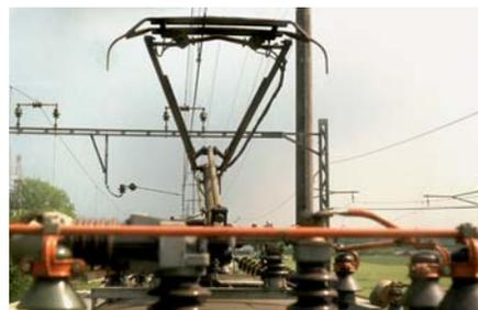
Der SBB-Stromabnehmer Bauart BBC-Es06 ist eine der wenigen Ausführungen von Einholmbügel, bei denen die Kuppelstange drückend über dem Unterholm liegt (Blick aus Kanzel des FL-Messwagens, 1982).
