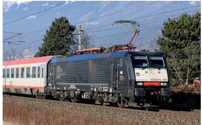
Auf den Mehrsystemloks ES 64 F4 befinden sich vier SBS2T, deren Paletten je nach Einsatzgebiet/System mit unterschiedlichen Kontaktmaterialien, Dimensionen und unterschiedlichem Anpressdruck arbeiten.
