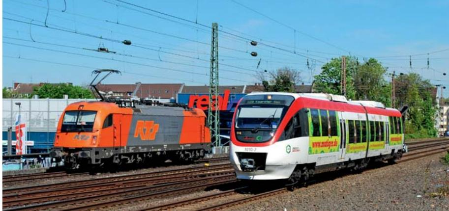
Noch kommen auf der Regiobahn-Linie S28 Dieseltriebzüge des Typs Bombardier Talent zum Einsatz, nach Ausbau und Elektrifizierung sollen Neufahrzeuge folgen.
