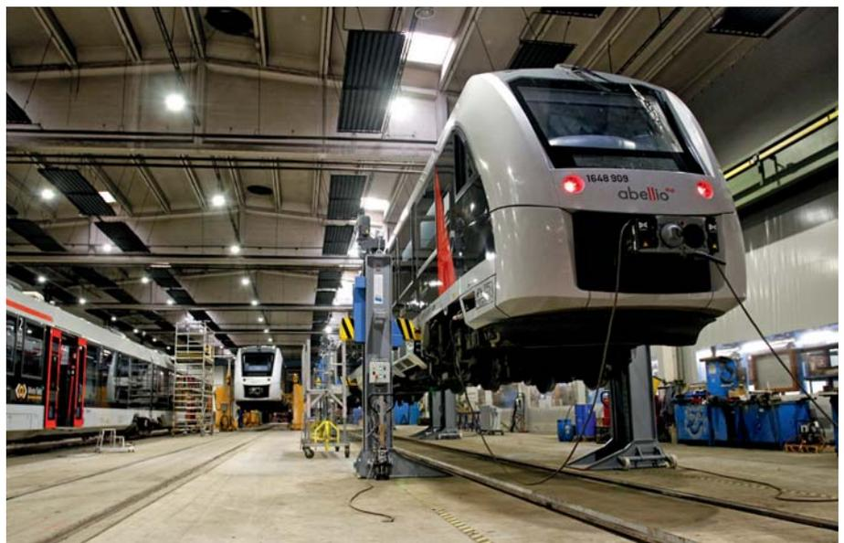
Der Durchlauf eines Fahrzeugs für eine vollumfängliche Revision (nach § 32 der Eisenbahn-Bau- und Betriebsordnung), die spätestens alle acht Jahre fällig ist, dauert etwa vier Wochen.
