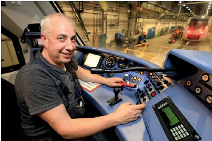
Bremsschlosser Holger Wendel führt nach einer Bremsuntersuchung im Führerstand eines Abellio-LINT noch abschließende Kontrollarbeiten durch.
