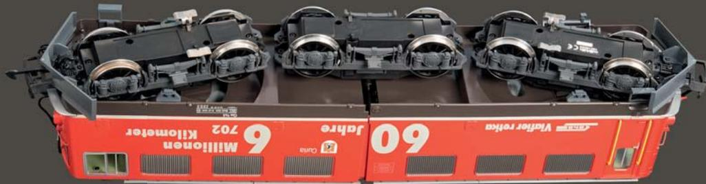
Mit dem vertikal wirkenden Gelenk zwischen den Lökkästen und einer enormen Beweglichkeit der Drehgestelle sind Entgleisungen praktisch ausgeschlossen.
