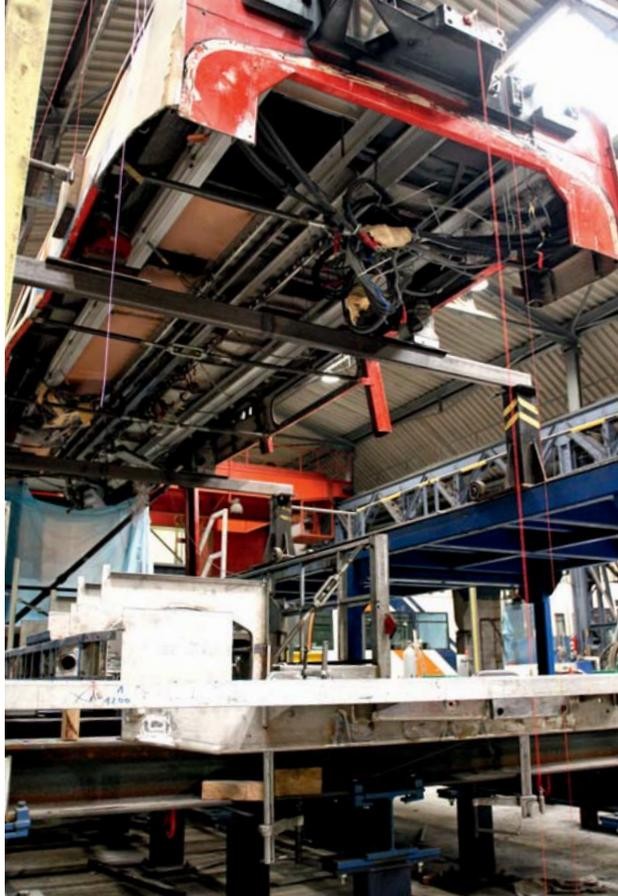
Bei der Ausbesserung von schweren Unfallschäden werden Fahrzeugkarosserieteile oft mit neuen Strukturen ersetzt.
