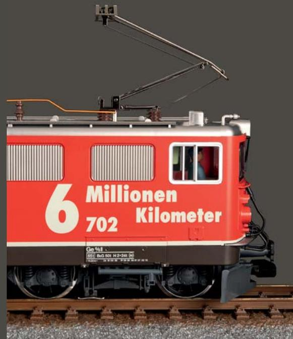
Griffstangen bestehen aus Draht, andere Einzelteile wie die Isolatoren, Luftleitungen und Scheibenwischer aus Kunststoff. Die Bedruckung ist makellos. Die Fabrikschilder und Wappen sind nicht erhaben.
