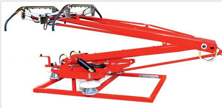
Der ATR95 für den HG-Zug ETR500 der FS macht das Gelenkviereck evident, das den gefächerten Oberarm in Stellung hält. Am Palettenkopf sind die gefederten und gedämpften Schwingen der Schleifstückhalterungen ersichtlich, unter dem Basisholm erkennt man den Luftfederbalgantrieb.
