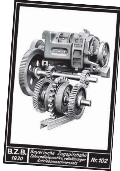
Drei solcher Zahnrad-Antriebssätze waren in den Bergloks vorhanden.
