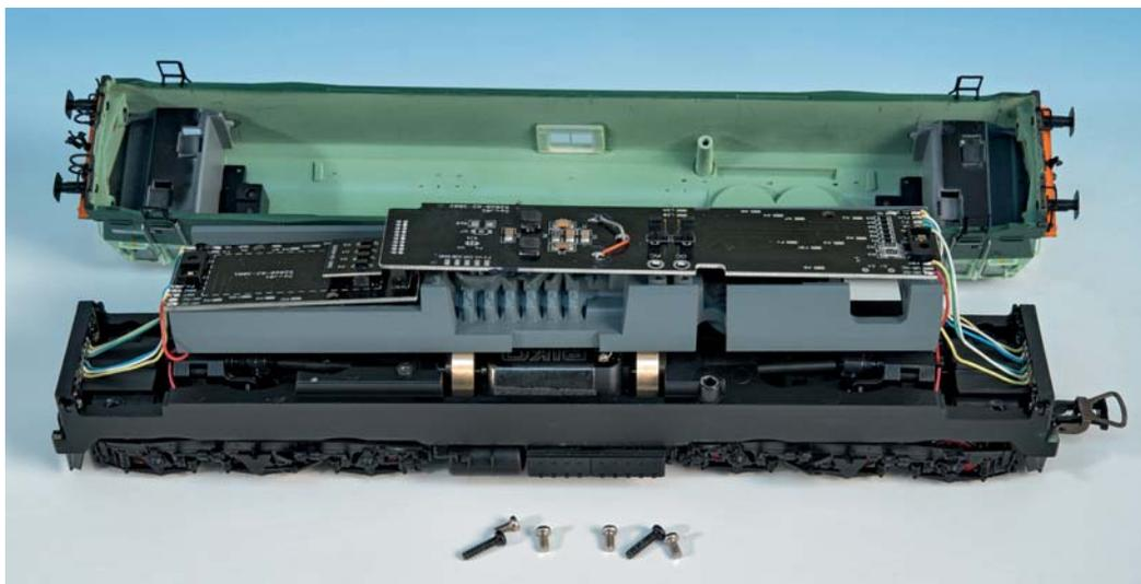
Der Fahrwerksrahmen und die darüber liegende graue Motorabdeckung bestehen aus Metall. Sehr gut wirkt die realistische Motornachbildung, die durch die Seitenfenster zu erkennen ist.
