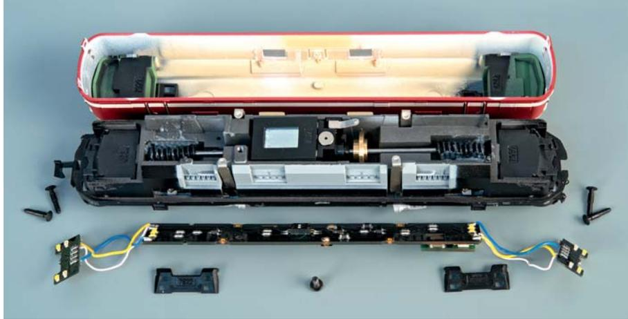
Noch typisch Fleischmann: die Platinenbefestigung mit vier Halteklammern. Die Next18-Schnittstelle liegt an der Unterseite der Platine. Ein Puffer ließ sich nur sehr schwer abziehen.
