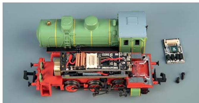
Unter der Platine mit Next18-Schnittstelle verbirgt sich ein Glockenankermotor, der mit der Schwungmasse für beste Ergebnisse bürgt.
