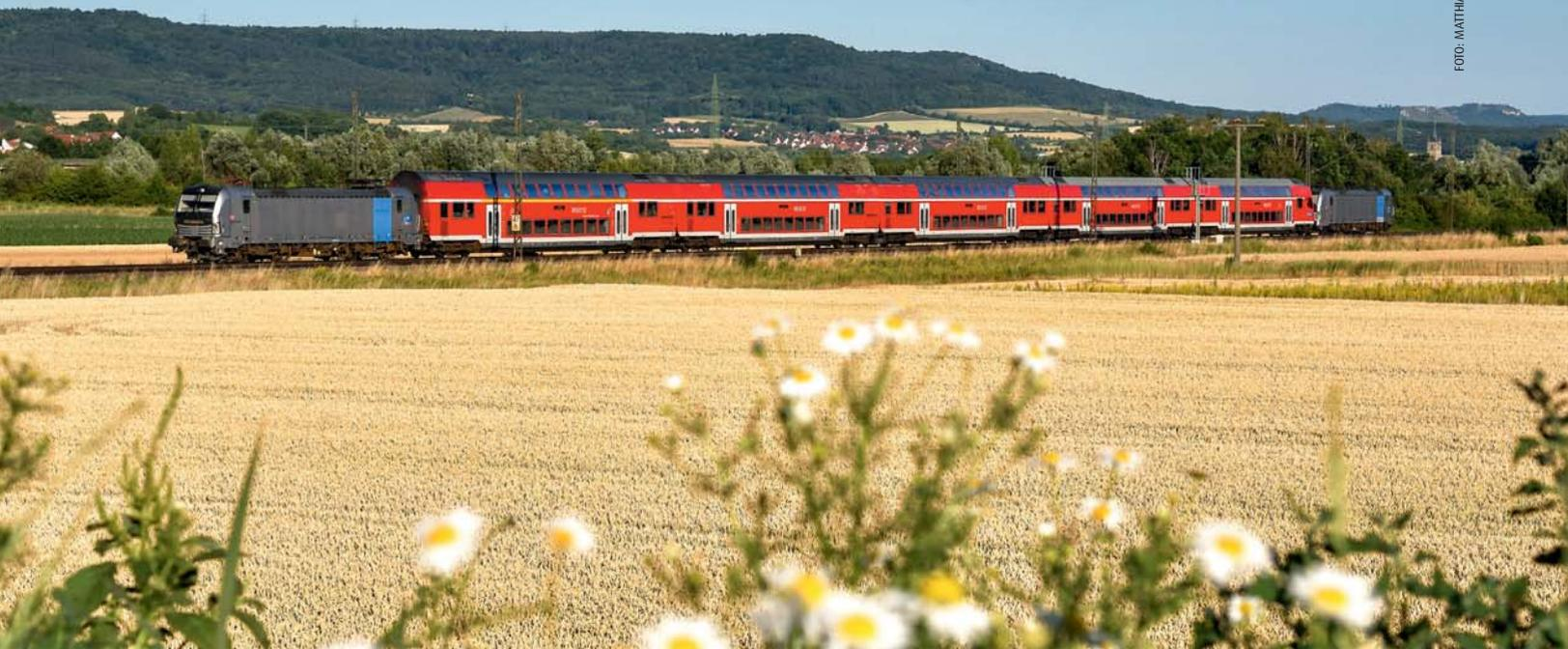
Seit 2017 vermietet Railpool fünf Lokomotiven des Typs Vectron an die DBAG. Die Maschinen sind mit dem Zugsicherungssystem ETCS ausgestattet, um für DBRegio Bayern den „Franken-Thüringen-Express“ Nürnberg – Sonneberg über die VDE8-Neubaustrecke zu befördern.
