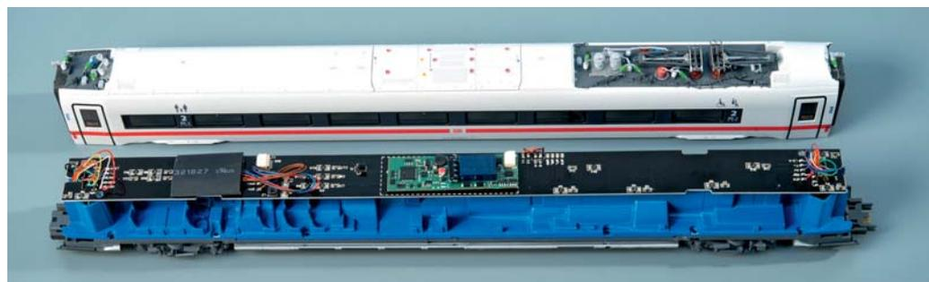
Der Modell-Antrieb sitzt in der Nachbildung des angetriebenen Servicewagens der zweiten Klasse. Die Platine trägt Decoder und Soundbaustein (links) sowie an der Unterseite die LED für die Innenbeleuchtung.
