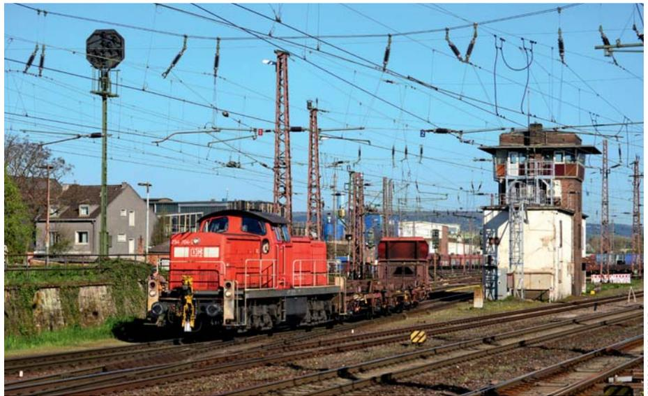
294704 stellt im Bahnhof Dillingen eine leere Erzzuggarnitur neu zusammen. Hinter der Lok sind Adapterwagen für die automatische Kupplung der Erzwaggons zu sehen.
