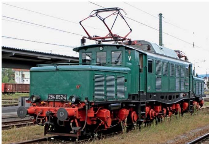
Die DR rüstete auch die rekonstruierten Altbau-Triebfahrzeuge mit neu gelieferten Scherenbügeln LEW-VS 28-25D aus, die in allen Maßen weitgehend dem DBS 54 gleichen (254 052 in Freilassung, Nostalgielok des dortigen Lokparks, am 17. Juli 2010).
