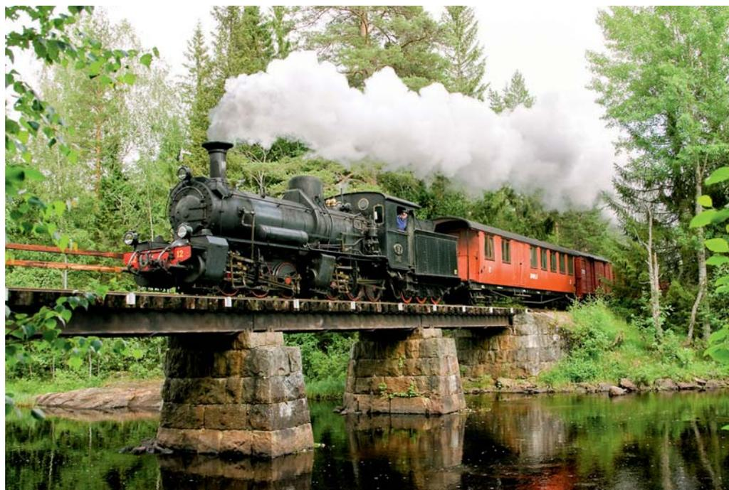
Die schwedische Museumsbahn Jädraås – Tallås besitzt zwei 58 Tonnen schwere Mallets von 1910. Lok 12 ist derzeit einsatzfähig, Lok 8 erhält eine Hauptuntersuchung.
