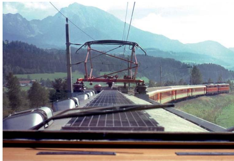
Stromabnehmer der Bauart ÖBB-V mit Wanisch-Palette als Messbügel auf dem Elektrotechnischen Messwagen 950.100.
