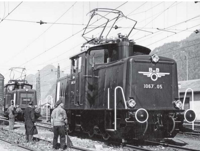
Stromabnehmer der ÖBB-Bauart V auf elektrohydraulischen Verschieblöks der Reihe 1067 in Jenbach am 9. Juni 1964.
