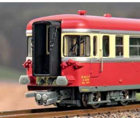
Sehr praktisch: stromführende Kupplung mit zwei Magneten.
