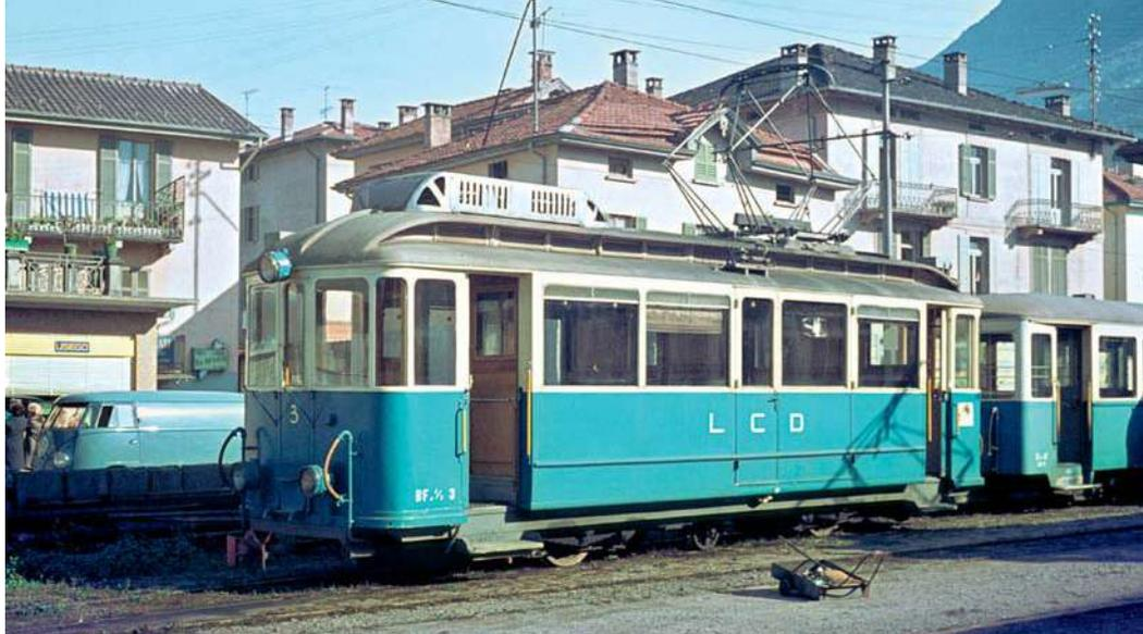
BF 2/3 Nr. 3 im Depot La Santa. Die vier ursprünglich zweiachsigen Triebwagen erhielten in den 1940er-Jahren dreiachsige Lenkachs-Fahrwerke mit mittiger Laufachse.
