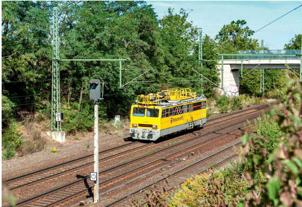
Seit 2009 gehören die Oberleitungs- und Tunnelinstandsetzungsfahrzeuge der Baureihe 711.0 zur Flotte. Insgesamt wurden 1995/96 neun Fahrzeuge dieses Typs für die DBAG gebaut.
