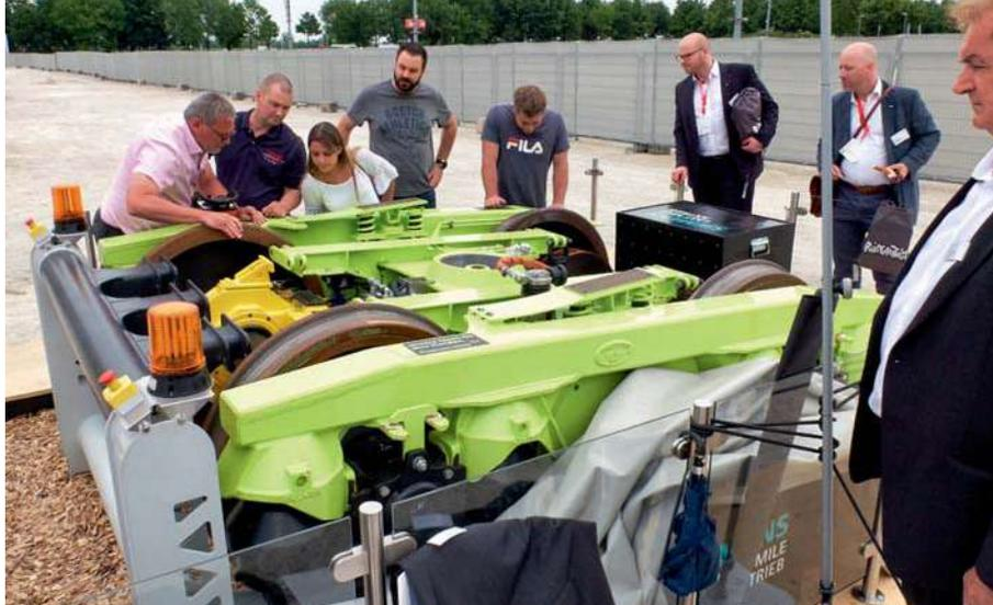
Für den automatischen Rangierdienst ist das von Siemens Mobility vorgestellte Güterwagen-Last-Mile-Drehgestell mit Elektroantrieb gedacht.
