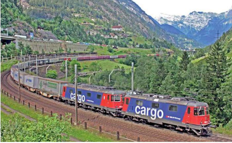
Re 10/10 an der Spitze: KLV-Züge erreichen je nach Art des Ladeguts meist eher die maximal zulässige Garniturlänge als das Höchstgewicht. Die rote Schiebelok kommt in der Wattinger Kurve der Gotthard-Bergstrecke 500 Meter weiter hinten gerade noch erkennbar ins Bild.
