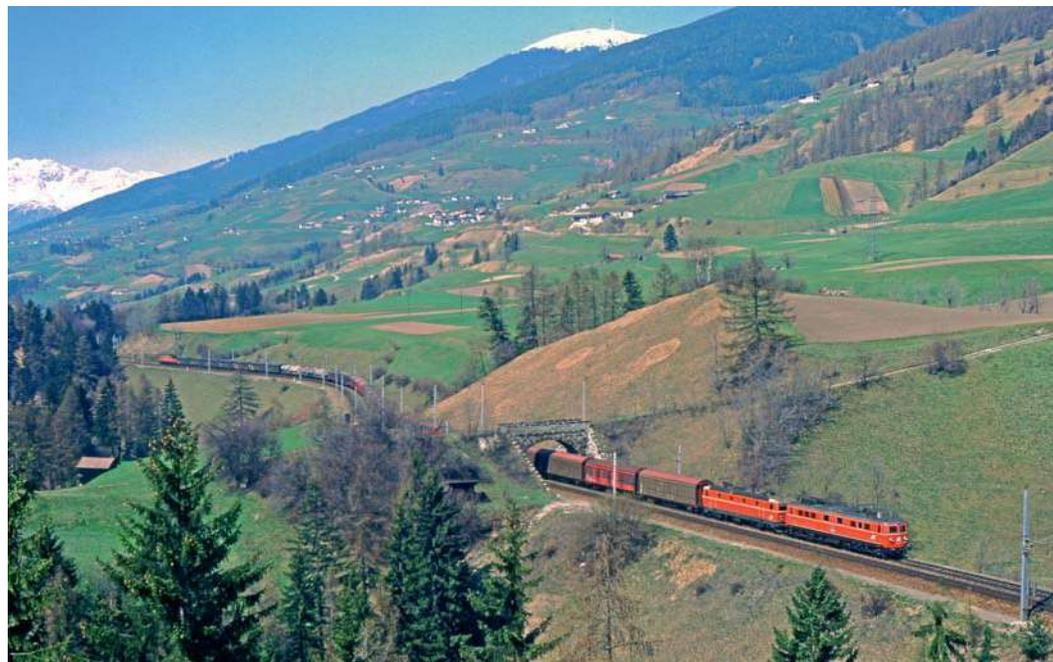
Matrie am Brenner am 29. März 1985: Schiebelokbetrieb bei einem 1500 t-Zug zum Brenner: 1110.5 und 1044 an der Spitze übernehmen 1010 Tonnen Zuglastanteil, den Rest (490 Tonnen) bewältigt die Schiebelok der Reihe 1020.
