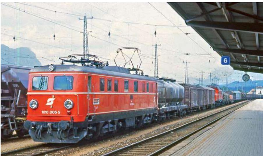
Zwischenlok auf der Giselabahn (Saalfelden – Wörgl) im Jahr 1987: Überstieg das Anhängewicht die für die Strecke normierte Zughakengrenzlast auch nur geringfügig, wurde die Über- last vor der zweiten Lok eingereicht.
