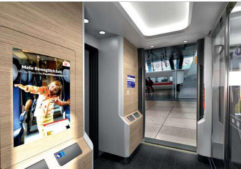
Der vergleichsweise niedrige Fahrzeugboden erlaubt einen stufenlosen Einstieg bei 760 Millimetern Bahnsteighöhe. Dank der breiten Türen können auch Rollstuhlfahrer selbstständig an Bord kommen.
