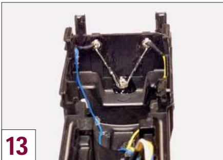
Die hinteren LED sind eingebaut und, hintereinander geschaltet, verdrahtet. Die Kabel wurden mit „UHU hart“ fixiert.
