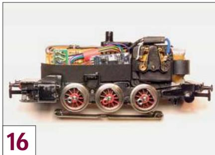
Das fertig umgebaute Modell. Mit aufgesetztem Gehäuse wird es dann für den digitalen Spielspaß bereit sein.
