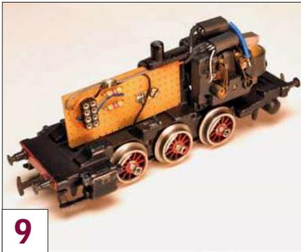
Die Platine ist eingebaut und mit Motor und Schleifer verdrahtet. Das Ganze wirkt wegen der wenigen Kabel noch recht aufgeräumt.
