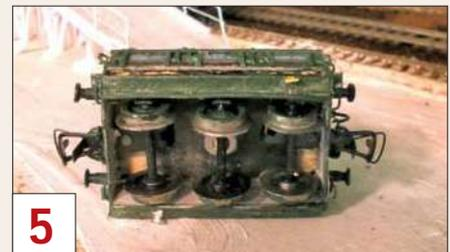
**5** Die Kupplungen werden mit zwei Nägeln im Holzkörper befestigt.
