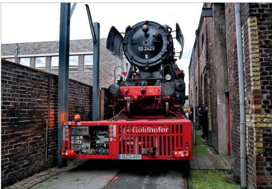
Die beengten Platzverhältnisse auf dem Gelände des LVR-Industriemuseums machten den Einsatz eines speziellen Tiefladefahrzeugs nötig.
