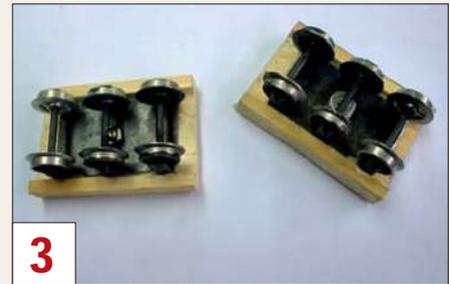
**3** Eine zusätzliche Metallplatte stabilisiert das Fahrwerk und sorgt für Gewicht.
