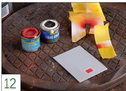
12 Das Rolltor für Stand 3 erhält ein Sh2-Signal, das in zwei Schritten aufgesprüht wird, erst weiß, dann rot.
