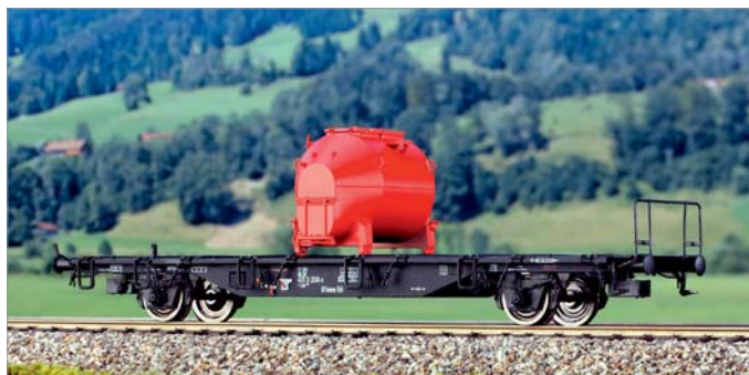
Von Haus zu Haus fährt der neue Container der Bauart Efr 401.
