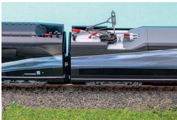
Auf dieser Aufnahme ist zu erkennen, dass die Welle an den Wagenübergängen einen geringen Versatz aufweist
