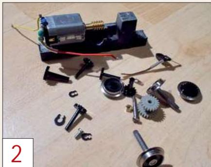
**2** Für einen System-Umbau wird auch das Fahrwerk in seine Bestandteile zerlegt.
