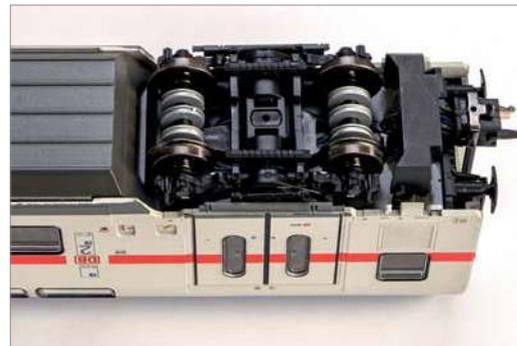
Am Rahmen der Görlitz-IX-Drehgestelle sitzen Nachbildungen der Magnetschienensbremsen, auf den Achsen solche der Bremsscheiben.
