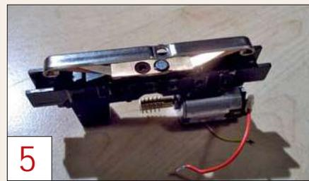
**5** Nach den Fräs-, Bohr- und Feilarbeiten streicht man das Fahrwerk mattschwarz.
