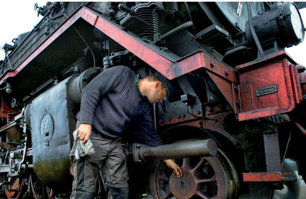
Betriebshalt und Abfühlen der Lagertemperatur der Vorlaufachse. Empfindlicher ist das hintere mittlere Treibstangenlager jeder 44, welches immer unter besonderer Beobachtung steht.
