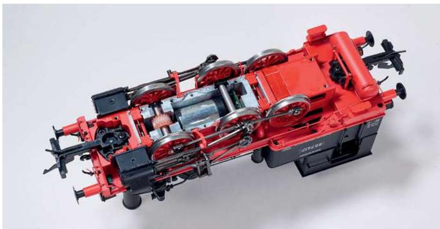
Der Blick von unten auf das Modell mit geöffneter Abdeckung zeigt die Lage des Motors und den Antrieb auf die erste Lokachse.
