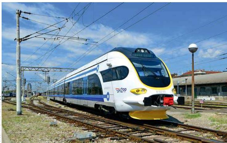
Mittlerweile übernehmen die modernen Elektrotriebzüge der Baureihe 6112 Teile des Vorortverkehrs in Zagreb.
