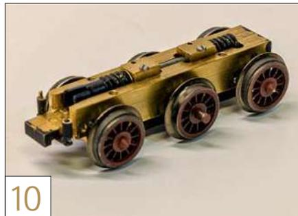
10 Der Tender-Antriebsblock: ein aus zwei Messingprofilen (5 x 10 mm) gefräster Eigenbau.
