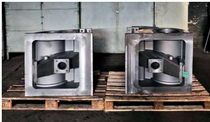
Im Rahmen der anschließenden Hauptuntersuchung im Dampflokwerk Meiningen erhielt die Lok vier neue Zylinder. Der Einblick in die am 3. Dezember 2016 bereits fertigen neuen Hochdruckzylinder ist nicht alltäglich.
