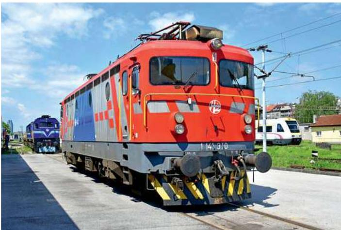
Die Wechselstromloks der Baureihe 1141 bilden das Rückrat der E-Lok-Flotte der HŽ. Ab 1968 entstanden mehrere hundert Exemplare nach Plänen der schwedischen ASEA. Viele Loks sind bei Bahnen in anderen Nachfolgestaaten des früheren Jugoslawien im Einsatz.
