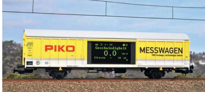
Hinter der Schiebetür sitzt ein Display, das die Messwerte anzeigt.
