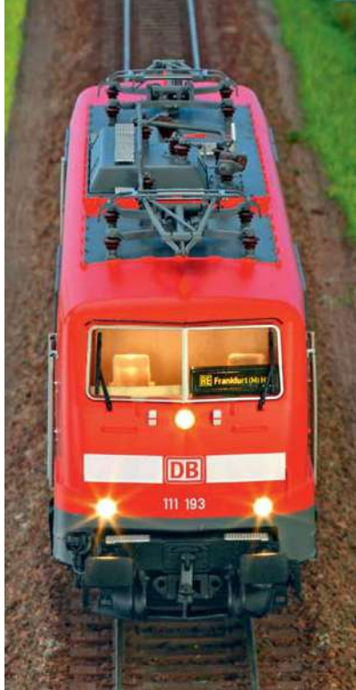
Mit Decoder sind auch die Führerstände und Zugzielanzeiger beleuchtet.
