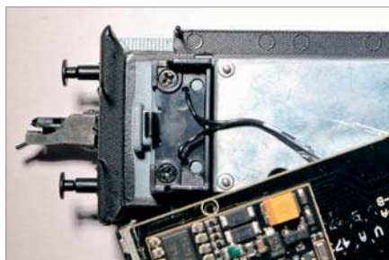
Das Bild zeigt die Löcher für die Kabeldurchführung in der Platinenhalterung.
