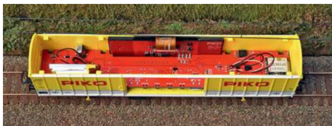
Auf der anderen Seite sind vier Taster zur Bedienung angeordnet.
