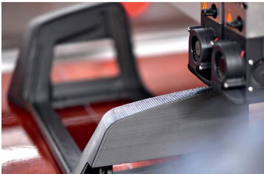
Auch große und massive Teile wie diese Kopfstütze lassen sich drucken. Um die vielen einzelnen Materialschichten aufzutragen, benötigt der Druck manchmal mehrere Tage.
