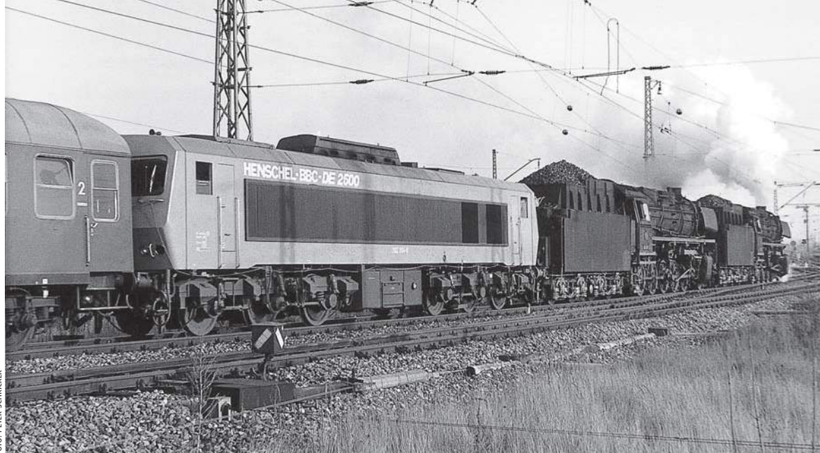
Welch ein Kontrast: Die kohlegefeuerten Dampflok 044404 und 427 dienten 1974 beim Einsatz eines Mess- zuges in München- Allach der hochmo- dernen 202004 als Bremslokomotiven.
