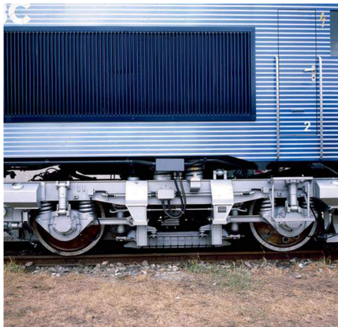
Die Drehgestelle der „UmAn“ waren die für die Forschung wichtigsten Komponenten des Hochgeschwindigkeits-Versuchsträgers.
