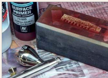
Nach dem Grundieren erhalten die Bleche eine erste Farbschicht in Rotbraun.
