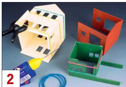
2 Die Grundkörper sind schnell zusammengesetzt. Gummiringe und Klemmen fixieren.
