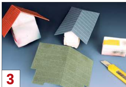
3 Größere Bauteile werden vor dem Lackieren auf Hartschaumklötzchen geklebt.
