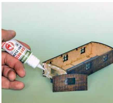
Wie bei vielen Lasercut-Bausätzen von Busch werden auch die Holzwände der Kranbrücke auf ein Pressspan-Grundgerüst geleimt.
