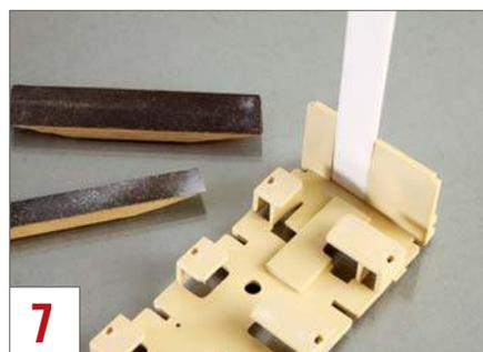
**7** Die Abteiltüren werden ausgeschnitten. Ein Polystyrolstreifen dient der Breitenkontrolle.
