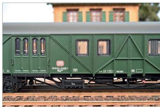
Der MDyG 986 unterscheidet sich von den Vorgängertypen unter anderem durch die glatten Seitenwände (beim Vorbild aus Phenolharzplatten).
