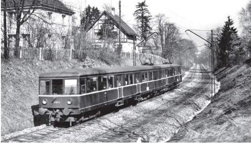
Den ET/ES 182 12 fertigte Wegmann in Kassel 1949 aus vier angearbeiteten Beiwagen der Berliner Bauart 1941. Günter Scheingraber begegnete dem Fahrzeug am 9. März 1952 an der Prinz-Ludwigs-Höhe.
