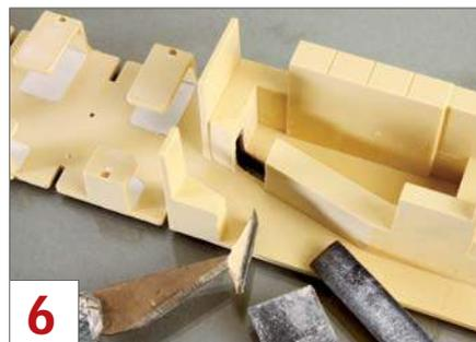
**6** An der Theke wird ein Durchgang herausgeschnitten und mit der Feile zurechtgeformt.
