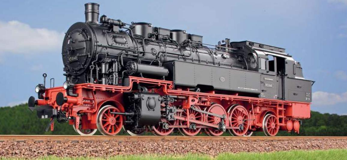
Fast ausschließlich aus Messing und Edelstahl besteht das Prachtmodell der Baureihe 93.5 für die Spur 0.
