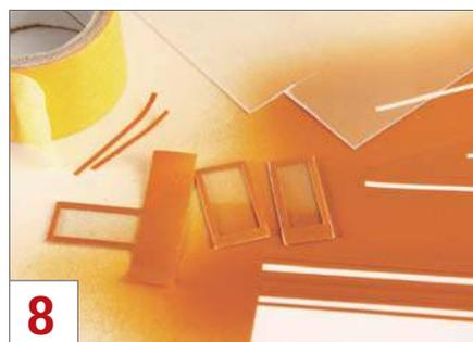
**8** Neue Türen entstehen aus transparentem Polystyrol und lackierten Tape-Streifen.
