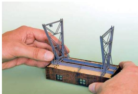
Bei der Montage der Portalstützen ist Finger-spitzengefühl gefragt, damit sich die Passzapfen aus Pappe nicht verwinden.
