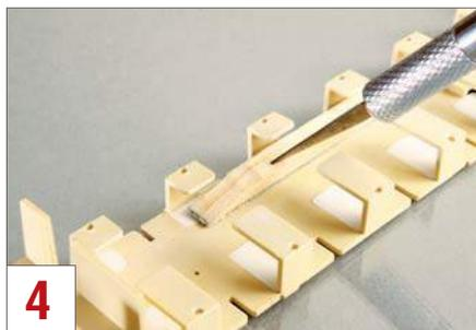
**4** Die Aussparungen unter den Tischen schließt man mit Polystyrolstücken (Stärke: 1 mm).
