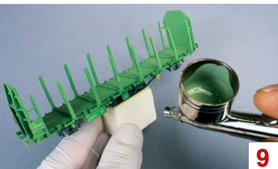
Die Farbe wird aus Tamiya-Produkten der XF-Serie gemischt und sehr dünn aufgetragen.
