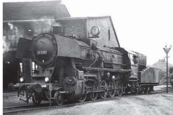
Mit ihrem Steifrahmentender und einem Oberflächenvorwärmer war 52 2011 selbst bei der DR eine eher rare Version der 52.
