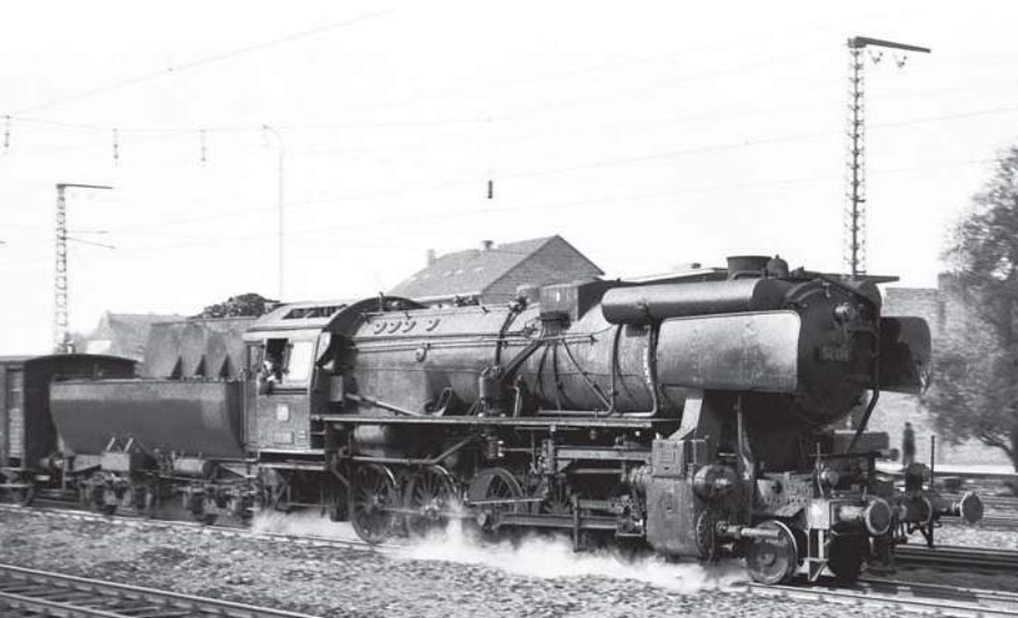
52 138 mit Henschel-Dreitrommel-Mischvorwärmer war eine der letzten 52 der Bundesbahn. Am 26. September 1959 passiert sie den Hauptbahnhof von Essen.
