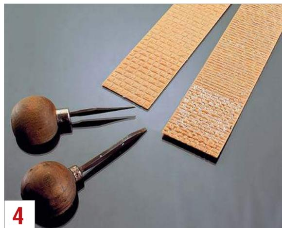
4 Mit zwei in Wippbewegungen geführten Flachsticheln entsteht die Fugenstruktur.
