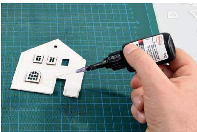
Zum Kleben kleiner Teile wie der Fenstereinsätze ist der verwendete Klebstoff nicht ideal. Es empfiehlt sich, die Kleinteile zunächst vorsichtig zu fixieren und anschließend, von außen unsichtbar, mit einer dünnen Lage Sekundenkleber von innen zu versiegeln.
