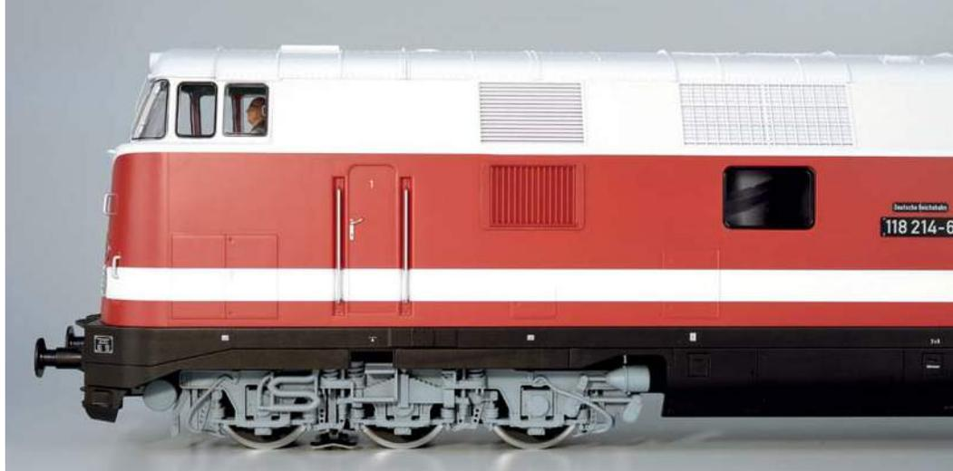
Lediglich im Bereich der Drehgestelle und des Rahmens werden die Maßstabs-Ungereimtheiten des Modells sichtbar, da die Gartenbahn-Spurweite mit 45 Millimetern eigentlich zu schmal ist.
