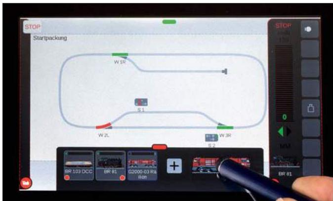
Zur Aktivierung des Fahrzeugs wird das Symbol zum Fahrregler gezogen. Die Bedienung mit Wischen und Ziehen erfordert etwas Übung.
