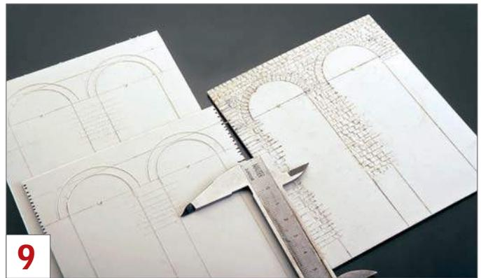
Sobald die erste Seitenwand fertig ist, greift man die Abstände der waagrecht Linien ab und überträgt sie auf die weiteren Wandteile
