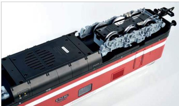
Ein nettes Detail sind die fein geätzten Gitter über den Lüftern. Leider sind die präzise nachgebildeten Ventilatoren nicht beweglich gelagert.
