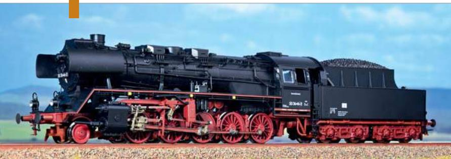
Nein, der Bereich unter dem Umlauf dieser 50.35 der DR ist nicht etwa verschmutzt, sondern braun lackiert.
