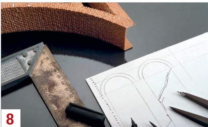
Damit sich die waagrecht Fugen der Hauptbrücke auf den Anbauten exakt fortsetzen, markiert man die Höhenabstände mit dem Filzschreiber. Die Bögen werden mit einem Stechzirkel, am besten von beiden Seiten, tief eingeritzt.
