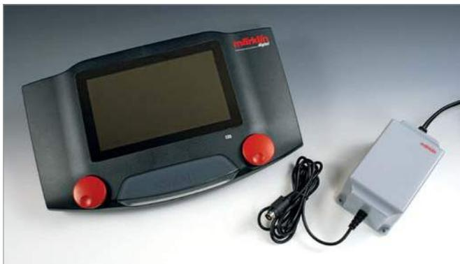
Zum Lieferumfang der CS 3 gehören neben der Zentrale eine sehr kurz gefasste Aufbauanleitung und zwei Gleisanschlusskabel. Zusätzlich wird ein so genanntes Schaltnetzteil (Art. Nr. 60061, 60101 oder 51095) benötigt.
