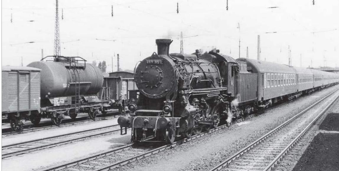
mensionierten Zweizylinder-Triebwerk befördert die Lok auch längere Güterzüge noch mit bis zu 75 km/h. Um die S160 in aller Welt freizügig einsetzen zu können, glich man ihr Lichtraumprofil dem in Großbritannien üblichen und damit dem kleinsten für Normalspur an. Zudem wurde die Achslast auf lediglich 16 Tonnen ausgelegt.
