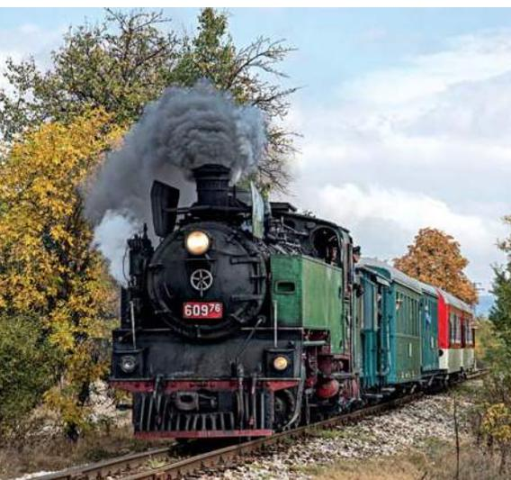
Die 1'E1'-Maschine 609.76 des Depots Septemvri fährt bei Kostandovo über einen relativ ebenen Streckenteil. Sie hat den steilsten Abschnitt der Rhodopenbahn noch vor sich.
