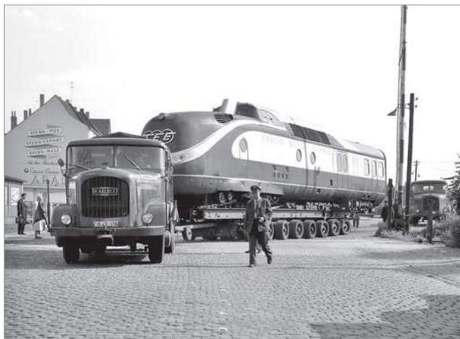
1960: Für die Ausstellung „Straße und Schiene“ auf dem Gruga-Gelände in Essen wird der TEE per Culemeyer-Straßenroller transportiert.
