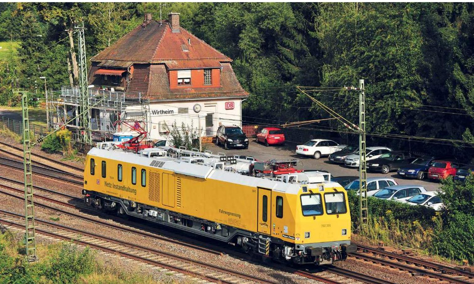
Der damals ebenfalls noch ganz neue Diagnose-Verbrennungstriebwagen (DVT) 702201 durchfährt am 29. August 2016 bei einer Fahrwegmessung mit gehobenem Mess-Stromabnehmer von Hanau kommend den kleinen Bahnhof Wirtheim in Richtung Fulda.
