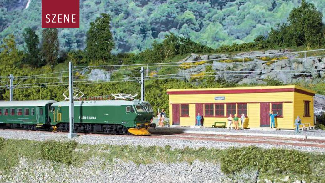
Typisch für die Flamsbahn sind die Pendelzüge mit EL 17-Sandwich-Bespannung. Die dort bis 2014 eingesetzten Loks trugen den Schriftzug „FLÄMSBANA“, der auch das NMJ-Modell zielt.
