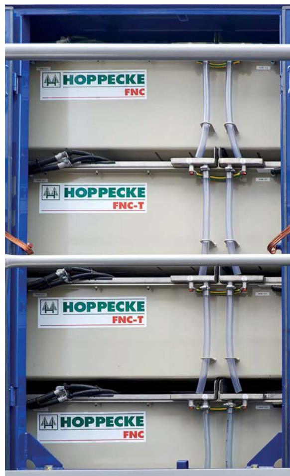
Das Batteriegerüst der 1002 011-7 der Metrans mit Nickel-Cadmium-Batterien der Firma Hoppecke.
