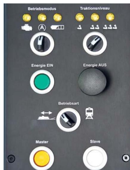
Am Betriebsarten-Panel der H3 kann man den Batterie-, Diesel- oder Automatikbetrieb sowie das Traktionsniveau auswählen und auf Rangier- oder Streckenbetrieb gehen.
