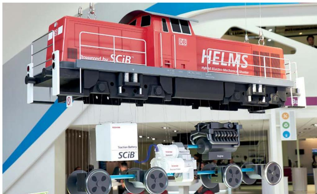
Derzeit nur als Modell: Das Projekt HELMS zur Modernisierung der Baureihe 294 der Deutschen Bahn verwendet ein Henschel-Planetengetriebe und Batterien sowie Motoren von Toshiba.
