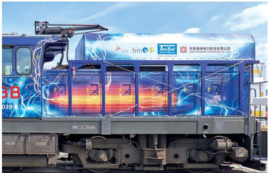
Gut zu erkennen ist der temporäre Aufbau des aus Batterien und Supercaps bestehenden Energiespeichers der 1063 039.
