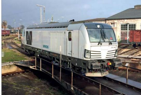
Die BayernBahn setzt aktuell eine dieselelektrische Lokomotive des Typs Vectron DE von Siemens vor den Güterzügen zwischen Nördlingen und Feuchtwangen sowie Nördlingen und
