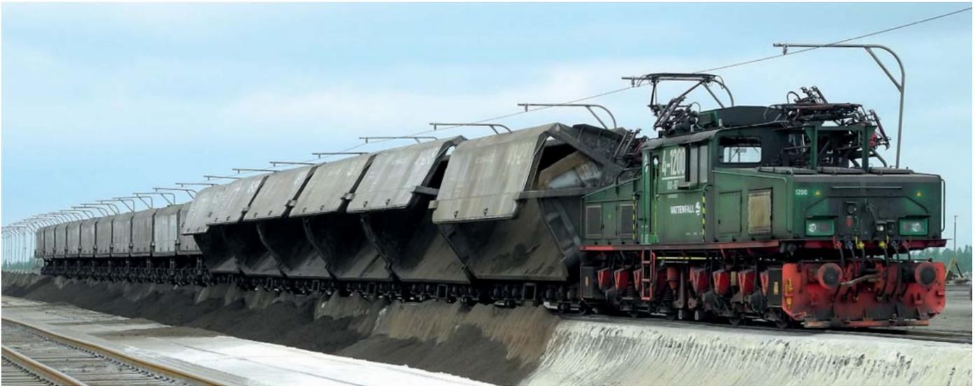
Entladen eines Zuges am Strossengleis in der Deponie II. Im Vordergrund sind Stahlhohlschwellen des rückbaren Absetzergleises zu erkennen.
