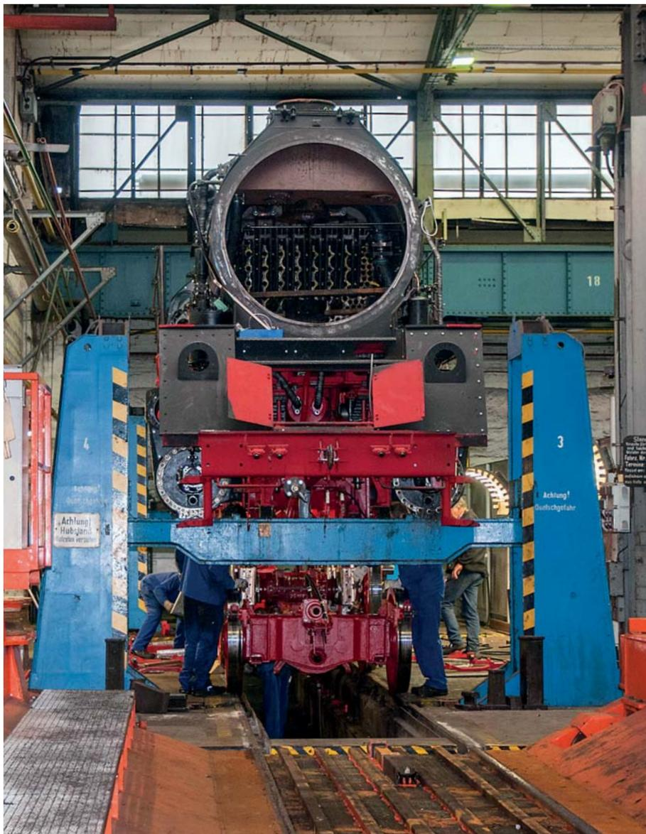
Sonderschicht am Samstag: Am 17. September 2016 ist die Hauptuntersuchung der Glauchauer 35 1097 im Dampfloswerk so weit fortgeschritten, dass aufgeachst werden kann.
