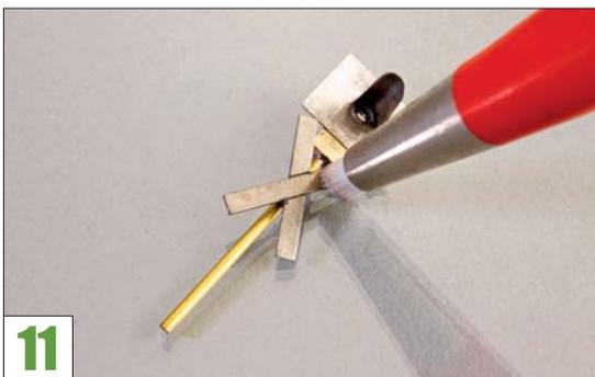
Vor der Farbgebung sollte man die Metallteile und Lötstellen mit einem Glasfaserstift reinigen.
