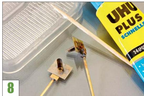
Zunächst werden die Blenden mit wenig Zweikomponentenkleber am Rahmenteil fixiert.
