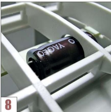
**8** Stromspeicher-Kondensator gegen Flackerlicht: Die extra ausgeschnittene Querspante lässt ihn im Oberlichtkasten verschwinden.
