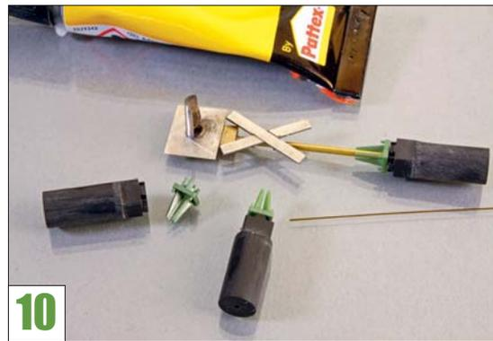
Das Verkleben erfolgt mit dünnflüssigem Sekundenkleber, der mit einer Drahtspitze zwischen Mast und Fuß geträufelt wird.
