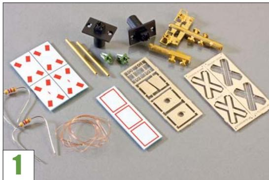
Der Bausatz besteht im Wesentlichen aus Messingguss, Neusilberätzteilen und Kunststoff-Sockel-Elementen.
