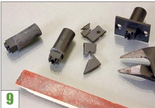
Zwecks Einbau in ein vorhandenes Diorama wird die rechteckige Bodenplatte abgezwickt und der Sockel rund gefeilt.
