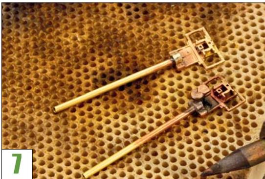
Die entgrateten Mastrohre und die Rahmenteile (oben ohne Lötwerk) werden miteinander verlötet.
