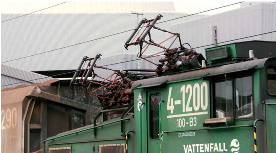
Zwei Seitenstromabnehmer an der EL2m. Der untere Fahrdrabt ist für die Traktionsenergie bestimmt, der obere dient als Zugvorholdraht.
