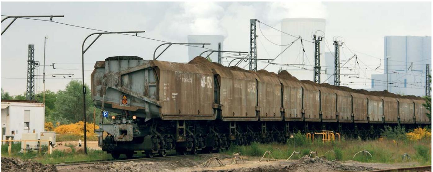
Übergang von der Kettenwerks- zur Strossenfahrleitung an der Deponie II. Im Hintergrund befindet sich das Kraftwerk Boxberg.
