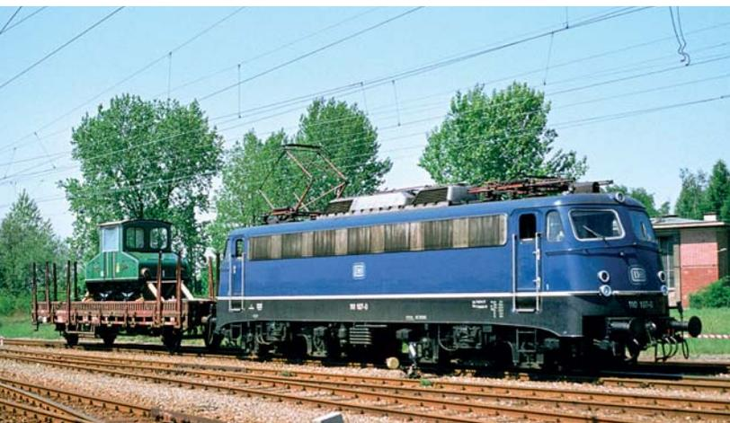
Die bei Kaltbeförderung ausgebrannte 110 107 (feste Bremsen) erhielt einen von Krauss-Maffei gelieferten kobaltblauen Bügelfaltenaufbau im AW Freimann. Dort verschiebt sie am 23. Mai 1979 eine S&H-Werklok.
