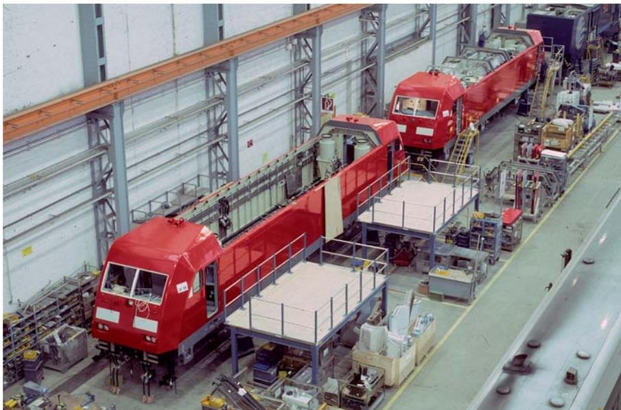
Ein Blick vom Kran der Adtranz-Fertigungshalle im Januar 1999 auf die leeren, bereits lackierten Gehäuse der Baureihe 101, die auf den Einbau der Leistungselektronik warten.
