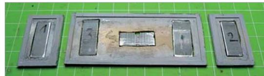
Die Eisenstreifen unter den Wechselplakaten wurden versenkt in die Plakatwand eingebaut. So passen sie mit den Magnetfolien (hier noch unbeklebt) bündig in den Rahmen.
