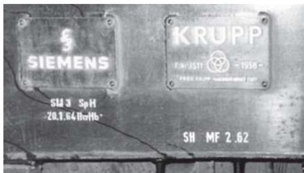
Unterhalb der Fabrikschilder von E 10 116 sind die Angaben zum Anstrich (rechts) und zum Schutzfilm (links) zu lesen: „SpH“ steht in beiden Fällen für Spies Hecker.
