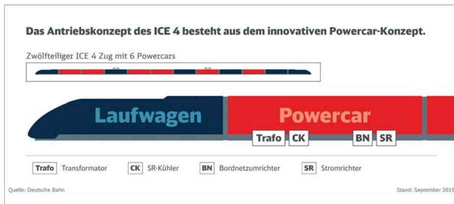
Der modulare Aufbau erlaubt es, ganze Baugruppen zu tauschen und außerhalb des Zuges zu reparieren. Das „Powercar“-Konzept soll weitere abgewandelte Baureihen ermöglichen.
