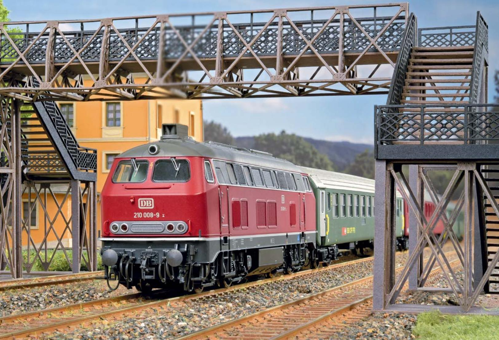
sei's drum. Auch das Ausklingen der abgeschalteten Turbine ist in Ordnung. Im Maßstab 1:87 könnte die 210 sogar ausschließlich mit der Gasturbine fahren. Beim Vorbild war das unmöglich; der Turbo ließ sich nur bei laufendem Dieselmotor aktivieren.
