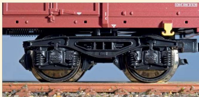
Das oben abgebildete Drehgestell ist kein Y25. Mit einem Achsstand von zwei statt der üblichen 1,80 Meter ist es der Bauart Y21 zuzuordnen. Bei diesem Spurwechseldrehgestell werden die Radsätze getauscht. Zu erkennen sind Abhebesicherungen an den Radlagern und die zugehörigen Seilanker am Rahmen. An der Roco-Nachbildung darunter gefällt besonders das plastisch ausgeformte SKF-Logo auf den Deckeln der Achs-Rollenlager.
