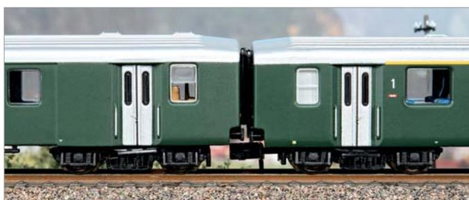
Gummiwulst an Gummiwulst zu fahren, gelingt mit der N-Standardkupplung nicht. Für Kurzkupplungen wird es dagegen sehr eng.
