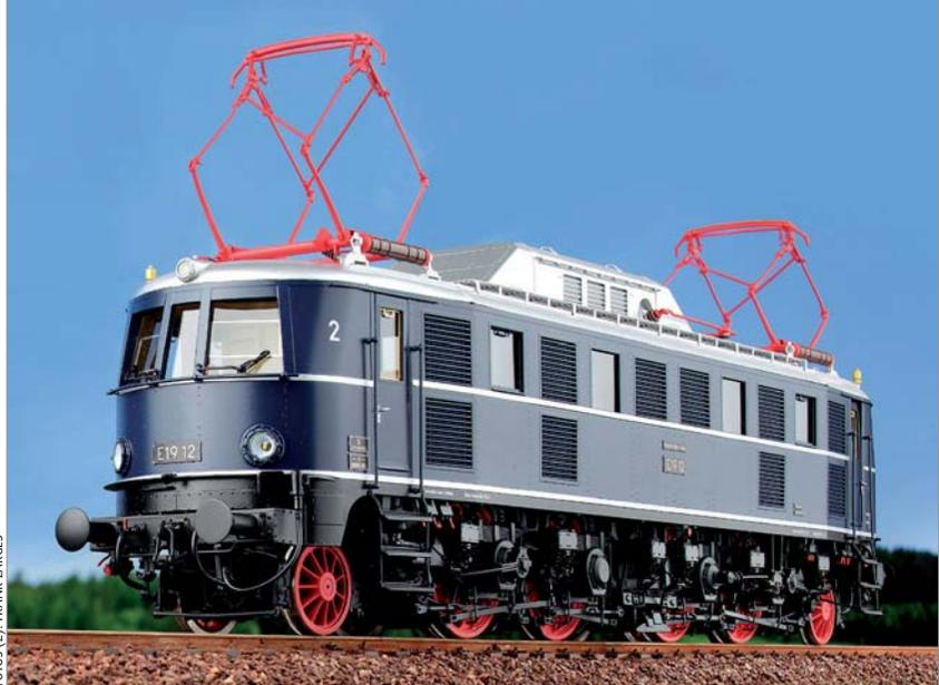
Auch am Modell akkurat nachgebildet ist das für E1911 und 12 charakteristische, außen liegende Bremsgestänge.
