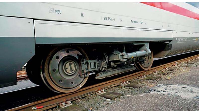
Im Gegensatz zu früheren ICE-Baureihen werden unter den nicht angetriebenen Wagen (leichtere) innengelagerte Laufdrehgestelle von Bombardier eingesetzt.
