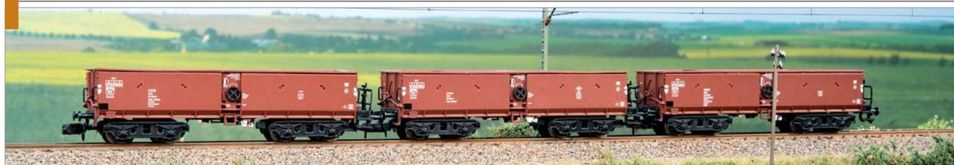
Die Selbstentladewagen der DR werden nun auch mit halbhohen Bordwänden mit der Gattungsbezeichnung Fadrr (OOHmtu) ausgeliefert. Sie laufen auf Niesky-Drehgestellen und sind, wie bei
