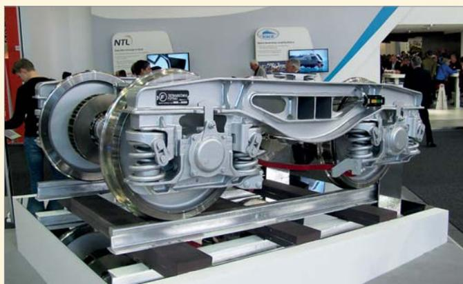
Das auf der Innotrans 2016 gezeigte NG-DBS („Next Generation-Disc Brake System“) von Tatravagónka Poprad ist die aktuellste Y25-Version und zeigt radial einstellbare Radsätze, Scheibenbremsen und Radsatzkoppelung.
