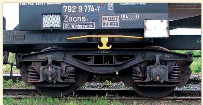
Die Bauart Y25Lsd in geschweißter Ausführung. Die linkssteigenden Schraubenfedern weisen auf die gegenüber dem Y25Cs erhöhte Achslast von 22,5 Tonnen hin, auch die doppelten Bremsklotzsohlen sind gut zu erkennen. Diese Bauform ist bislang noch nicht im Maßstab 1:87 umgesetzt worden, wohl weil die Modellbahnhersteller den Unterschied zum Y25Cs als vernachlässigbar betrachten.
