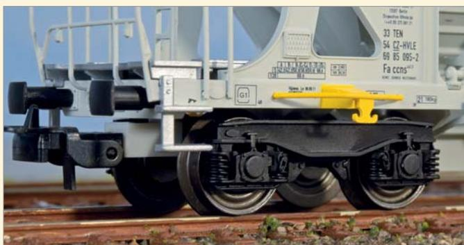
Das Y25Lsi(f)-C (das C steht für „Compact Disc Brake“) ist eine Weiterentwicklung des Y25 mit vereinfachter Formgebung und einer samt Bremszylinder im Drehgestellrahmen integrierten Bremsanlage. Die Kompaktbremse erlaubt den Verzicht auf Rahmen-Kopfstücke. Diese Bauart ist bereits als Nachbildung im H0-Maßstab erhältlich: unter dem von Tillig entwickelten Faccs-Schüttgutwagen, der auch bei Märklin zu haben ist.
