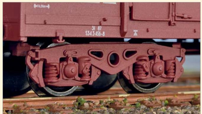
Das Y25Csm (m für „moulé“, frz. Guss; d für Doppelbremsklotzsohlen) mit Wiegeventil in gegossener Ausführung. Durch das Fehlen der Verstärkungsstreben am Längsträger unterscheidet sich diese Version augenfällig von der geschweißten Bauart. Das für unser Modellbild herangezogene Miniatur-Pendant von Liliput enttäuscht leider mit schlechter Gravur der Federn und Achslager und viel zu weit außen liegenden Bremsbacken.
