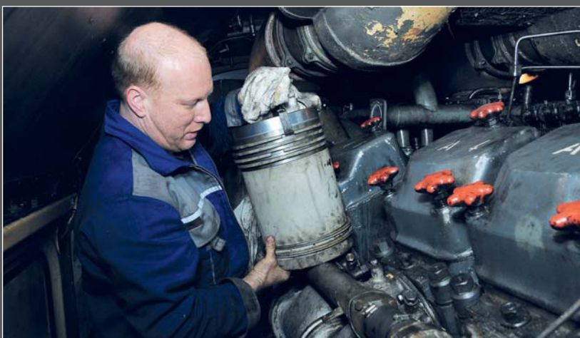
Am Zwölfzylinder aus Kolomna werden alle Laufbuchsendichtungen ausgetauscht. Dabei sind auch die Alu-Kolben auszubauen.
