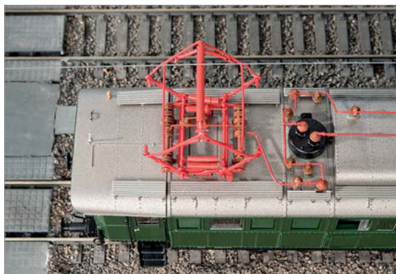
Der Dachbereich gefällt mit filigranen SBS-10-Stromabnehmern und vollständiger Leitungsführung.
