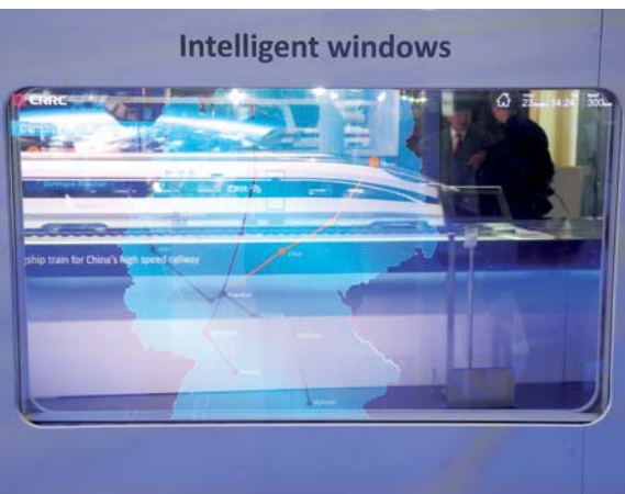
Die CRRC zeigte Fahrgastfenster, die auch als multifunktionale Bildschirme dienen können.
