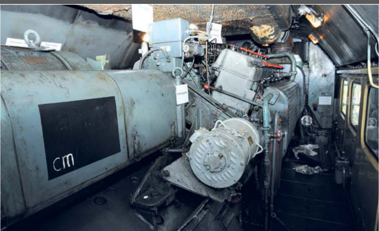
Eng wirkt der Motorraum der 120 174. Links unterhalb des Motors liegt der Generator, oberhalb der Schalldämpfer der Bauart Lugansk.
