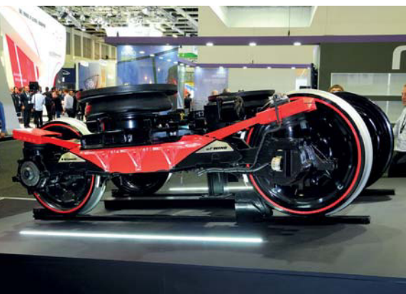
Kawasaki stellte ein Hochgeschwindigkeitsdrehgestell mit Carbonfederung (rot) vor.
