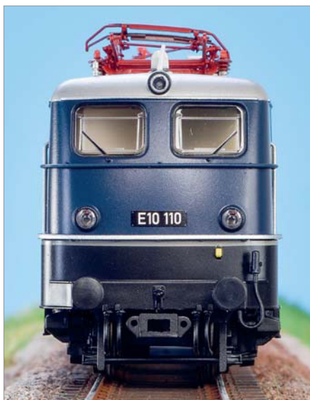
Die Lokfront entspricht exakt dem Vorbild. Wie schon bei der E 41 von Piko sind auch die Stirnleuchten der E 10 perfekt wiedergegeben.
