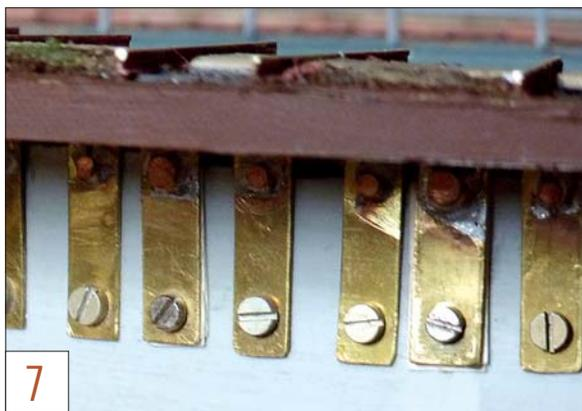
Die Kupferkontakte am Scheibenrand sind von hinten außen mit leicht federnden Messingblechstreifen verbunden.
