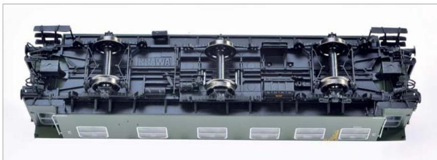
Das Fahrwerk präsentiert sich mit einer vollständig nachgebildeten Bremsanlage und feinsten Details auf dem bei Brawa üblichen Niveau.
