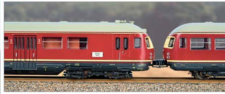
Trieb- und Steuerwagen werden mit einer funktionsfähigen, kulissengeführten, jedoch nicht stromführenden Nachbildung der Scharfenberg-Kupplung verbunden. So wie im kleinen Bild sollten die Fahrzeuge zueinander stehen.
