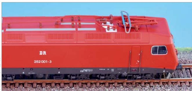
Die vergleichsweise einfache Dachausrüstung ist vollständig wiedergegeben, an den Stromabnehmern stören die zu groß ausgefallenen Schleifstücke, die dem sicheren Modell-Oberleitungsbetrieb geschuldet sind.
