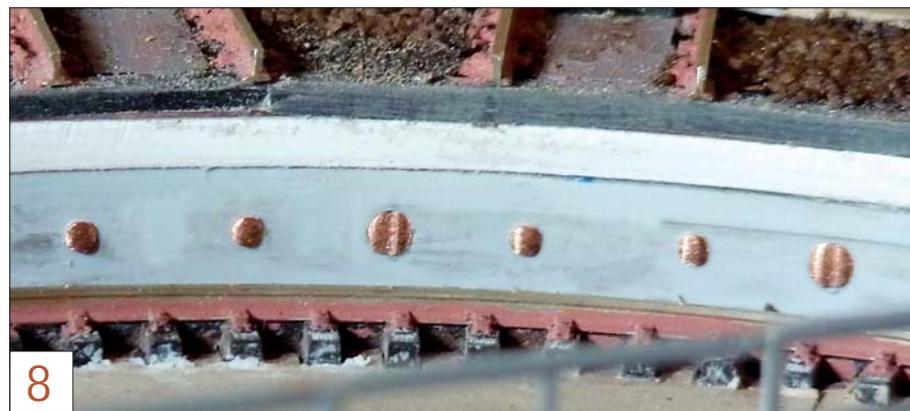
Die großen Punkte stellen die Ausschaltkontakte dar, während die kleineren Kupferkontakte die Umpoleinheiten bilden. Wichtig ist der exakte Abstand.
