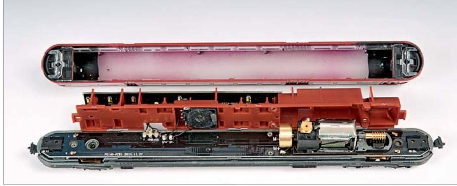
Das Gehäuse ist oberhalb des grauen Rahmens aufgesteckt. Darunter liegt die Inneneinrichtung mit Motorabdeckung und Beleuchtung. Der Motor wirkt vorbildentsprechend auf ein Drehgestell.
