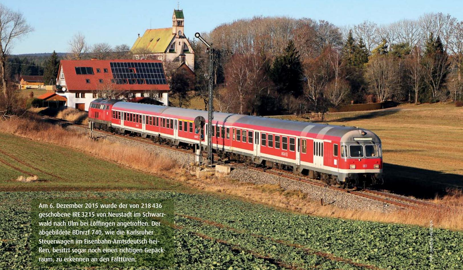
Am 6. Dezember 2015 wurde der von 218 436 geschobene IRE 3215 von Neustadt im Schwarzwald nach Ulm bei Löffingen angetroffen. Der abgebildete BDnrzf 740, wie die Karlsruher Steuerwagen im Eisenbahn-Amtsdeutsch heißen, besitzt sogar noch einen richtigen Gepäckraum, zu erkennen an den Falltüren.
