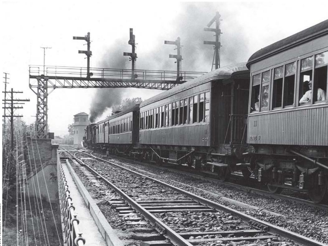
Am 26. August 1968 unterquert ein ausfahrender Eilzug eine Signalbrücke in Lerida. Die hölzernen Plattformwagen wirken beinahe wie aus der Belle Époque. Zugmaschine ist eine 141f.
