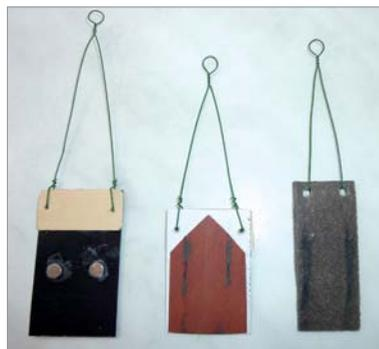
Der Schleifschlitten links zeigt die Oberseite mit Neodym-Magneten zur Führung auf den Gleisen.
