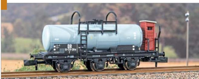
Unter den neuen dreiachsigen Kesselwagen im Maßstab 1:160 ist auch eine Variante der DR mit Epoche-III-Beschriftung. Laut Anschriften erhielt der RIV-fähige, bei der DR eingestellte Privatwagen seine letzte Untersuchung im Raw Jena am „16. Juni 62“. Die Detaillierung des Modells ist ansprechend, die Materialstärke der Geländer und der Preis dürften aber geringer ausfallen.
