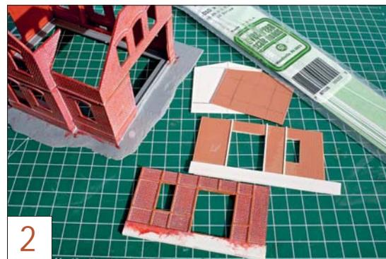
Der Schuppenanbau entsteht im Selbstbau aus Polystyrol-Platten und -Profilen von Evergreen und Slaters.
