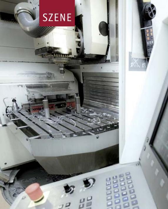
Modernes CNC-Bearbeitungszentrum: Auf solchen computergesteuerten Fräsmaschinen werden die Rohlinge der Spritzgussformen für neue Faller-Bausätze angefertigt.
