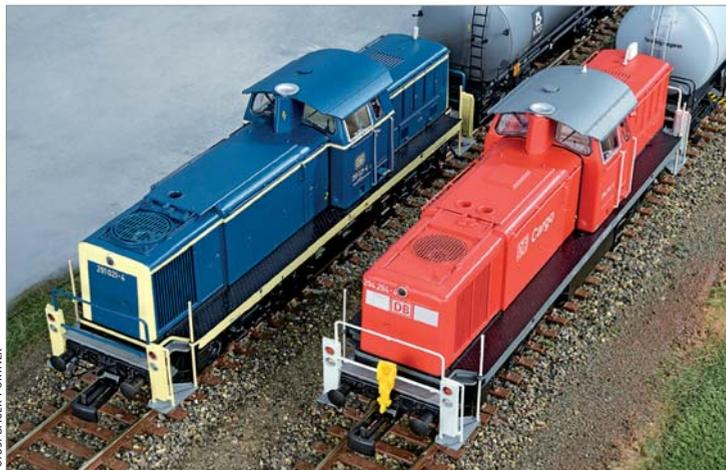
Die Epochen-Varianten unterscheiden sich in vielen Details, so besitzt die 294 unterhalb des Führerhausdaches beispielsweise die Leuchtmelder für den Funkbetrieb. Die 291 wartet ebenfalls mit Formänderungen auf.
