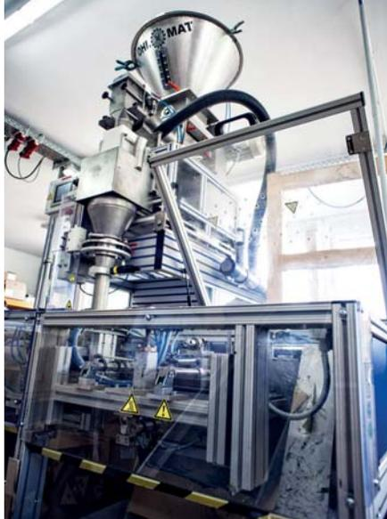
Die Packmaschine für jegliches loses Material, vom Streumaterial bis zu Kleinteilen.
