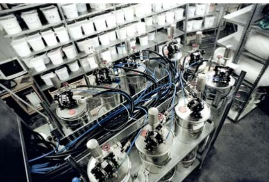
Die Farbmischanlage für Kunststoffgranulat sorgt für die realistische Bauteil-Kolorierung.
