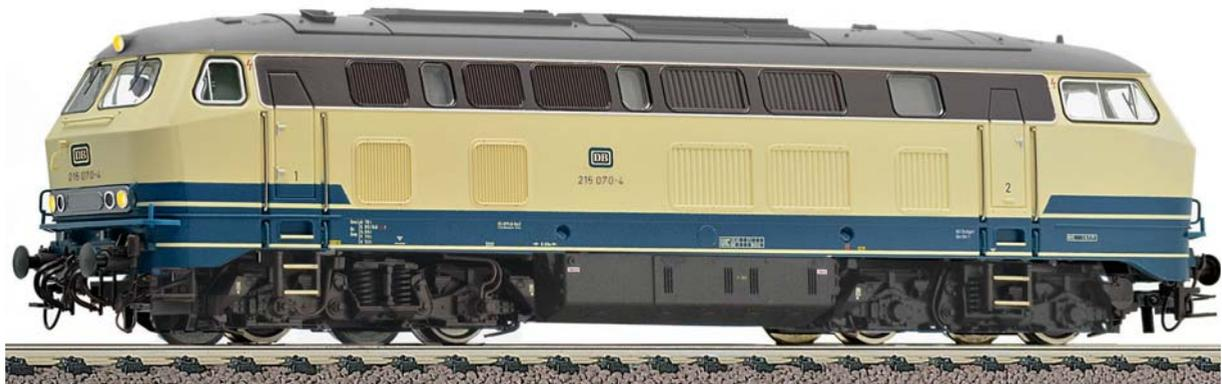
Die BR 215 war die letzte Diesellok der DB, die noch mit einer Dampfheizung ausgeliefert wurde. 690 Liter zusätzlichen Brennstoff führten die Lokomotiven an Bord, um das Wasser in ihren ölgefeuerten Durchlaufkesseln erhitzen zu können.
