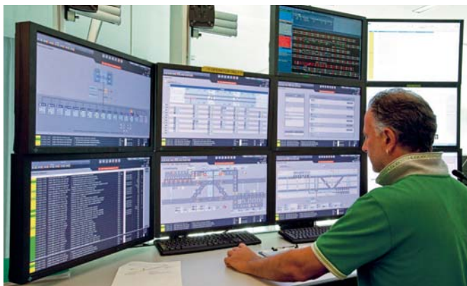
Die provisorische Kontrollzentrale des GBT. Auf den beiden rechten unteren Monitoren sind die Multifunktionsstellen zu erkennen.
