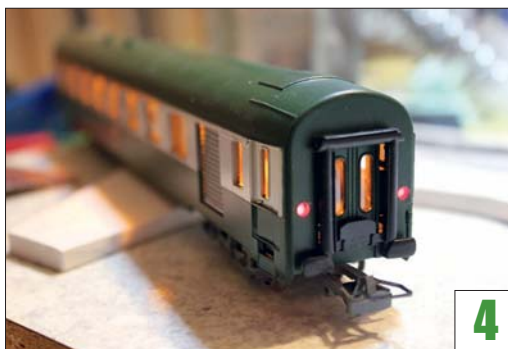
Die Wagen-Be- leuchtung im Testbetrieb: Schaut gut aus! Der Wagenkas- ten wurde in- nen schwarz bemalt, um Durchscheinen zu vermeiden.
