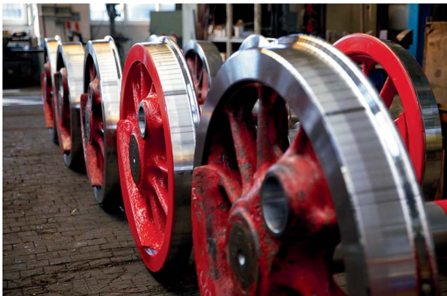
Mit neuen Radreifen versehen, wartet die Radsatzgruppe der 997232 auf den Einbau. Gut ist die exakte Profilierung zu erkennen. Die Maschine soll in Kürze in den Harz zurückkehren.
