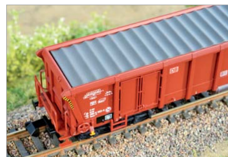
Charakteristisch sind das Rolldach und der zugehörige Öffnungsmechanismus.
