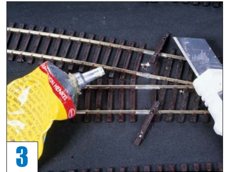
3 Die bei Isolier-Verbindern entnommene Schwelle klebt man wieder an.
