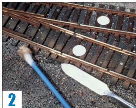
2 Bei lockeren Gleisverbindern kann die Farbe unterkriechen, dann kratzt man sie weg ...
