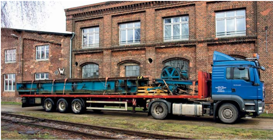
Ankunft in Wittenberge. Auf dem Sattelschlepper liegen ein Teil der Drehscheibenbühne sowie der Antrieb und warten darauf, entladen zu werden.
