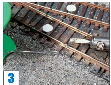
3 ... und lässt flüssiges Lötzinn als Stromleiter in den Schuh und Gleisspalt laufen.
