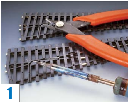
1 Bei Peco-Gleisen löst man die Drahtbrücke aus der vertieften Schwelle und kürzt sie, ...
