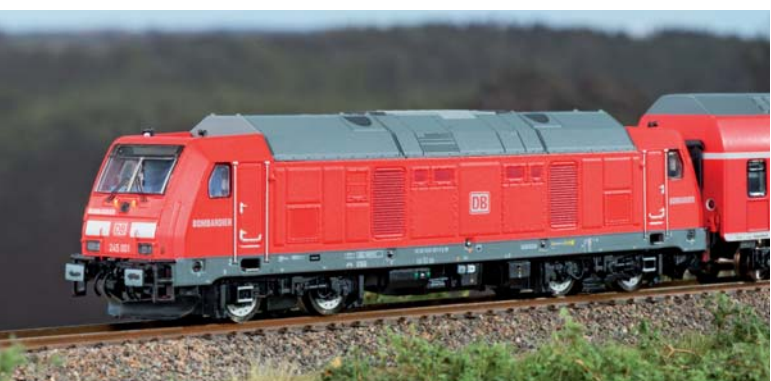
Das Arnold-Modell der 245 weist prägnantere Gravuren auf, dafür sitzt der Lokkasten leider etwas zu hoch über dem Gleis.
