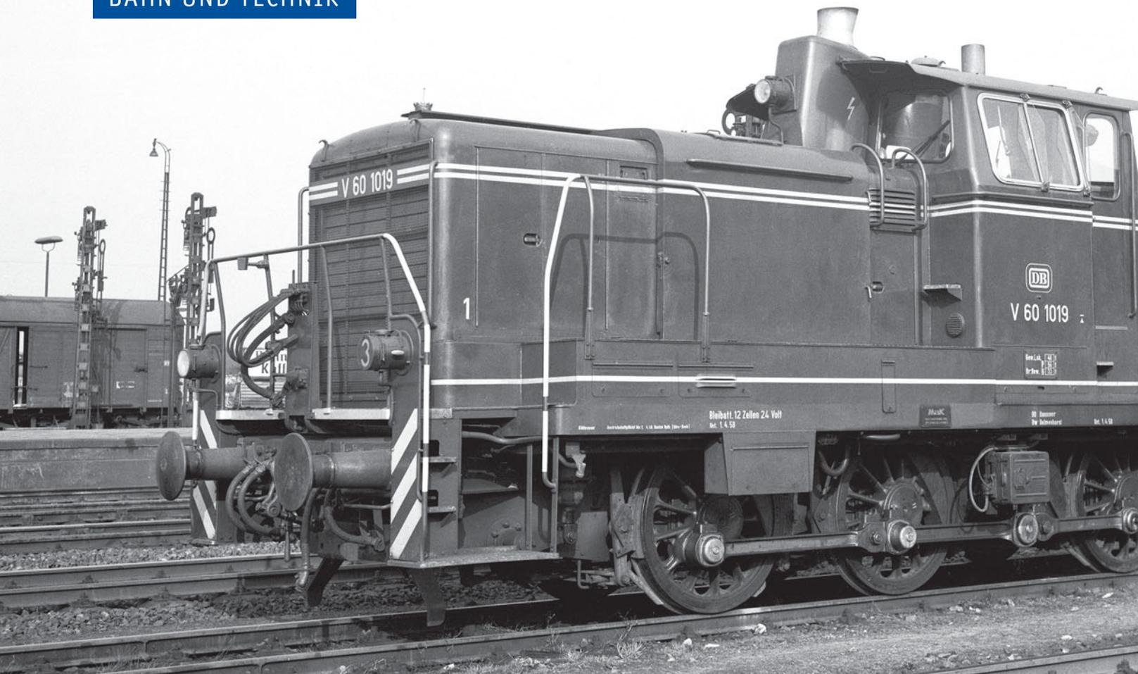
Pneumatische Doppeltraktionssteuerungen waren bei der Bundesbahn die Ausnahme. Lediglich bei der Baureihe V60 wurden sie ausprobiert, ein Versuch, der am Ende zwar nicht scheiterte, aber überflüssig wurde.
