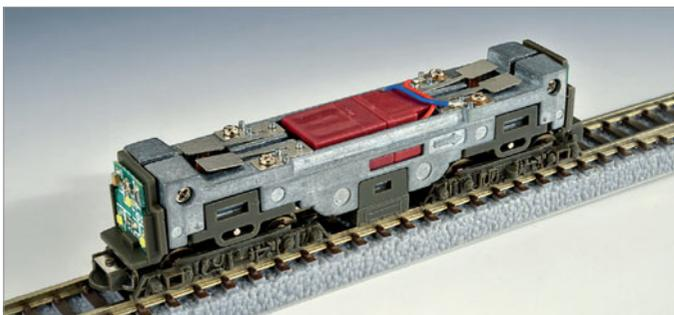
Aufgeräumt zeigt sich das Lok-Innere: In einem massiven Metallrahmen ruht der Motor, oberhalb bleibt Platz für einen Decoder.
