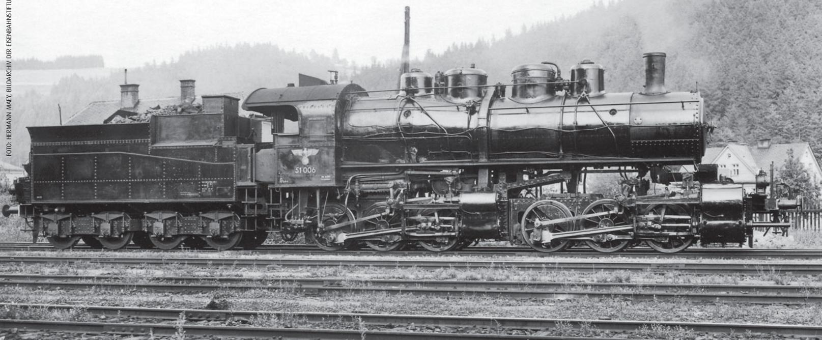
Europas meistgebaute Mallet: Der ungarischen Baureihe VIm entsprach diese Lok der Kaschau-Oderberger Bahn, die bei der DRG als 51006 lief. 16 Maschinen wurden als DRG-Baureihe 51 eingereiht und waren in den Bahnbetriebswerken Hannsdorf und Nieder-Lindewiese (Bild) stationiert.
