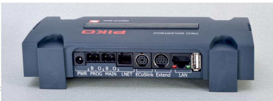
Vielseitige Anschlussmöglichkeiten bietet die Digital-Zentrale, die gleichzeitig als WLAN-Router fungiert. Der „LocoNet“-Anschluss weist derzeit noch in die Zukunft, Updates sind angekündigt.
