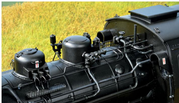
Den Metall-Kessel zieren zahlreiche Anbauteile aus Kunststoff und Metall (beispielsweise Trittstufen mit Riffelblech, Handlauf, Ventile und Sandfallrohre). Die Elektroleitungen sind angeformt.
