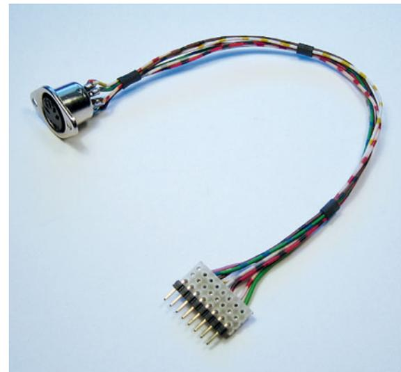
Das Kabel zur DIN-Buchse am Anlagenrand kann mittels Flachstecker vor dem Regler eine zusätzliche Trennmöglichkeit bekommen.
