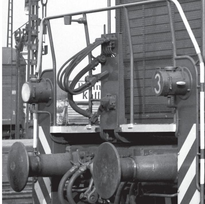
Die pneumatischen Verbindungen im Detail. Auf diesem Bild nicht angeschlossen sind die elektrischen Leitungen, die über die untere Dose verbunden werden.
