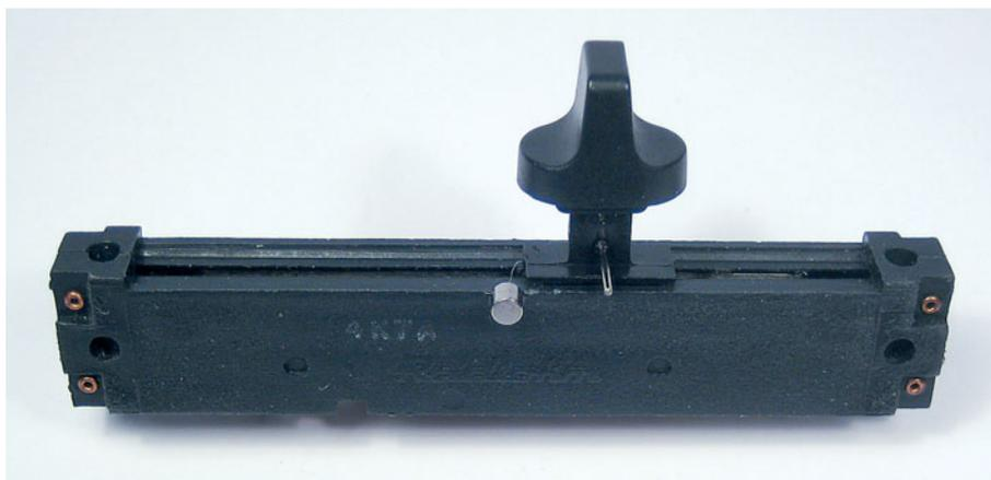
Ein rastender Mittelpunkt kann gegebenenfalls mit einem außen mittig angeklebten Neodym-Magneten und einem in eine Bohrung im Schieber eingeklebten Eisenstift erzeugt werden.
