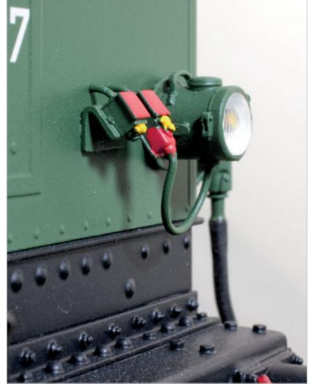
Perfekt nachgeformt: Elektro-Steckdosen und DB-Lampen mit eingesetzten Reflex-Gläsern.
