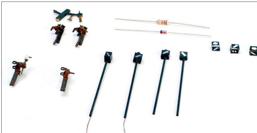
Die verschiedenen Laternenbausätze bestehen aus Lagerbock und Stellhebel, Messingröhrchen, Laternenkörper und -verkleidung (Ätzblech) sowie gegebenenfalls einer Mini-LED, einem Vorwiderstand und einer Diode. Der Handstellhebel (l.o.) ist extra erhältlich.
