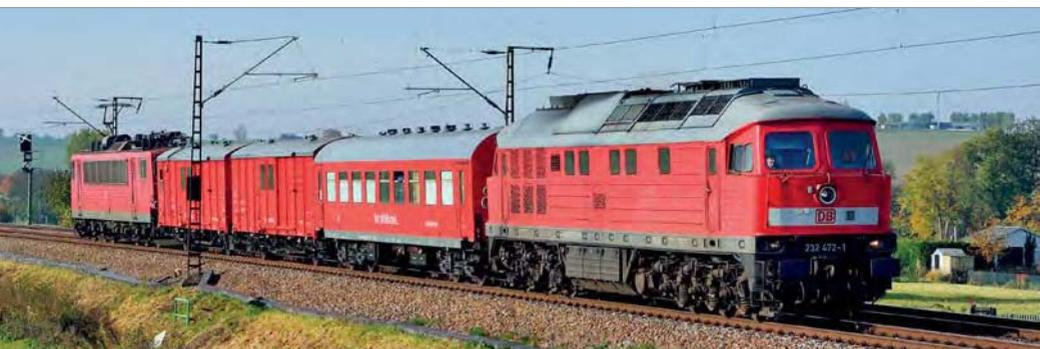
■ Weil sich 155 138 eine gravierende Flachstelle eingefahren hatte, wurde sie am 24. Oktober 2015 nach Halle geschleppt. Zum Einsatz kamen der Engelsdorfer Hilfszug und die Diesellok 232 472. Aber anstatt die defekte Lok auf Hilfsdrehgestelle zu bocken, ließ man die 155 am Zugende laut klagend hinterherhumpeln. Mit zirka 30 km/h fuhr das Gespann bei Mockern zwischen Lehdorf und Altenburg.
