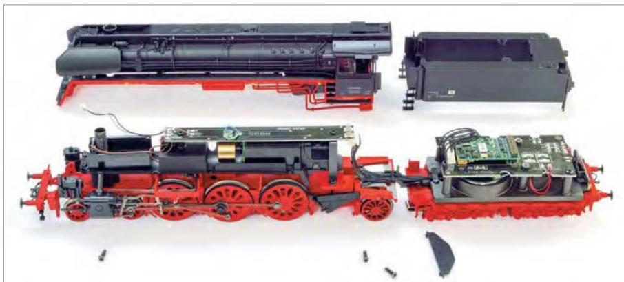
Der Zugang zum Innenleben ist einfach. Das Tendergehäuse ist zweiteilig, wobei das obere Bauteil ohne Werkzeug einfach abgezogen werden kann. Dann liegt der Decoder frei.
