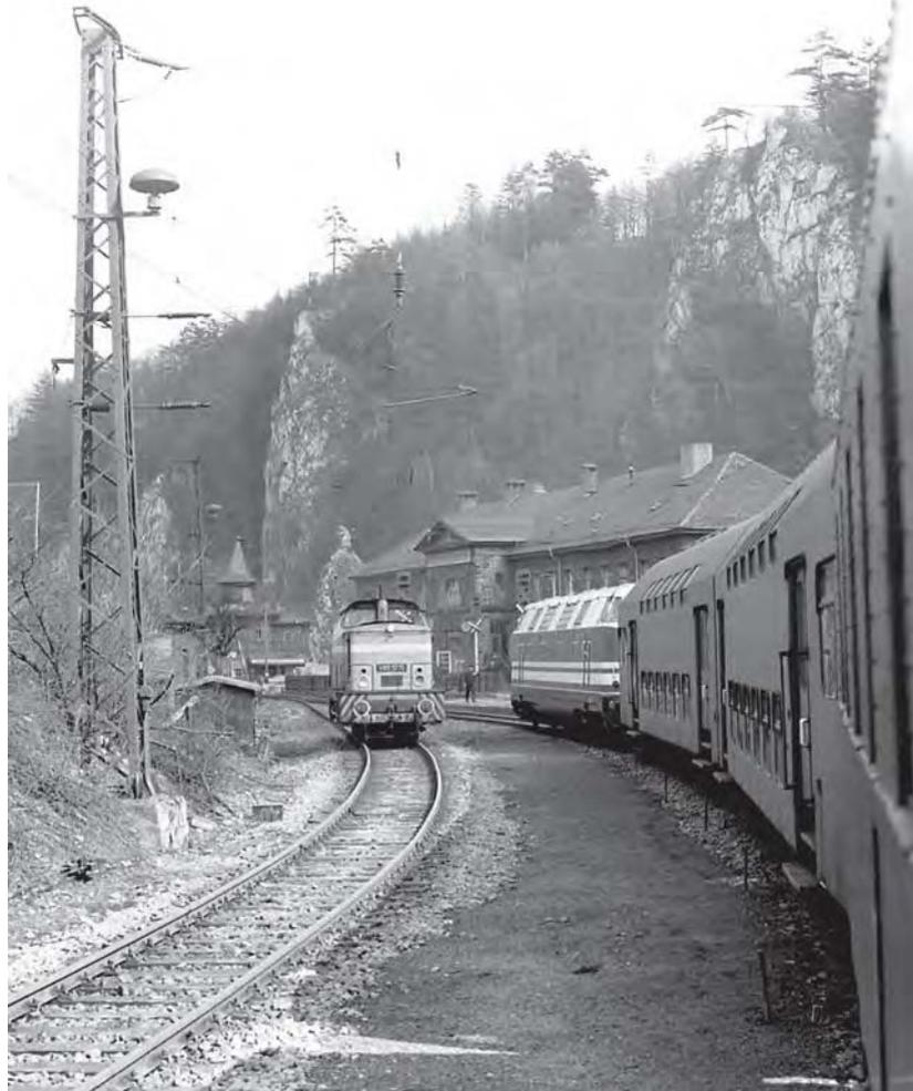
Dienstvorschrift Steilstrecke (DV 465) nach einer dritten unabhängigen Bremse. Die Güterzüge wurden in der Regel mit einer Zug- und einer Schiebelok gefahren. Das ersparte das Umsetzen in der Spitzkehre Michaelstein. Diese Betriebsweise wird bis heute durchgeführt. Bergwärts waren für
