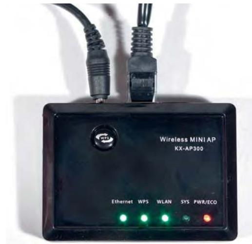
Der Accesspoint im Betrieb. Oben in der Mitte steckt das Ethernetkabel, das zur ECoS führt, links daneben ist das Steckernetzgerät angeschlossen. Verdeckt ist hier die USB-Buchse, die zum Laden des Handregler-Akkus verwendet werden kann.
