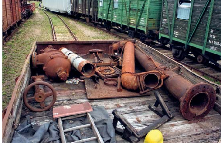
Zur Sammlung des Staßfurter Museums gehört gegenwärtig ein zerlegter Gelenkwasserkrane von der Firma Bopp & Reuther aus Mannheim.
