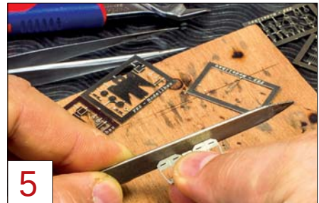
5 Eine kleine Diamant-Feile aus dem Kosmetik-Bedarf hilft dabei, die Grate der feinen Messingbauteile zu entfernen.
