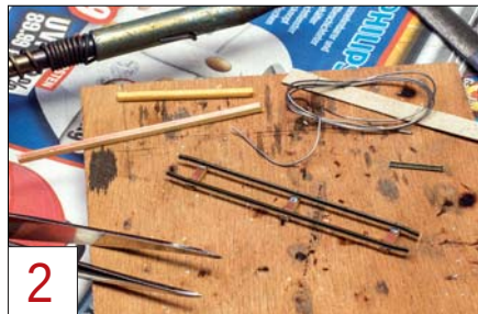
2 Code-40-Gleisprofile, auf Pertinax gelötet, begrenzen die für Nebenbahnen typische Füllung zwischen den Profilen.
