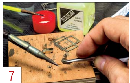
7 Die Teile des Schrankenbocks werden jeweils aus einem Teil gefaltet und anschließend verlötet. Lötöl leistet dabei gute Dienste.
