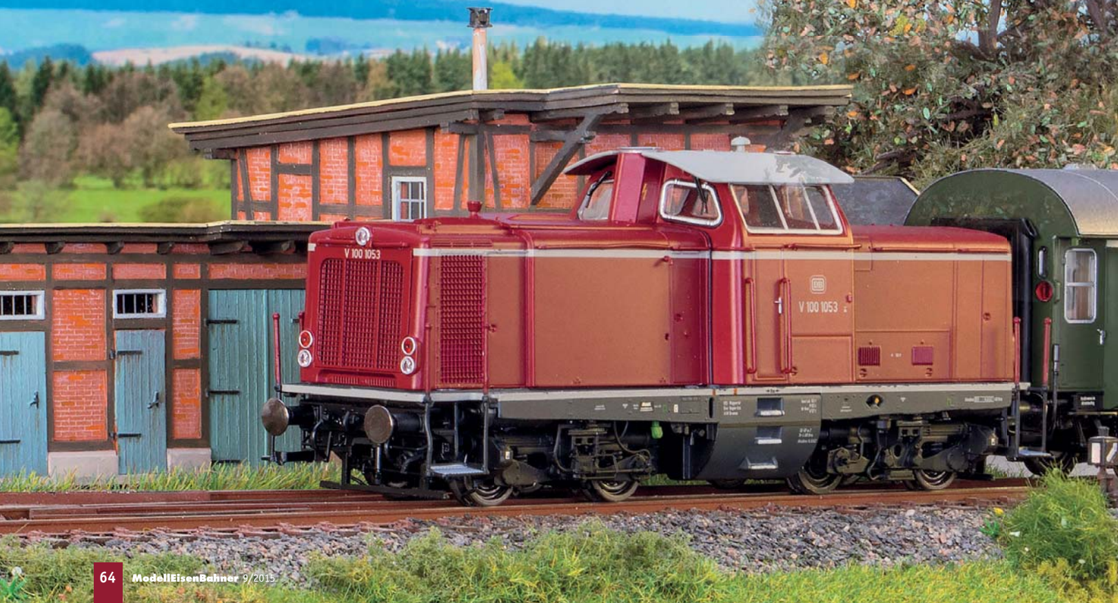
Das geätzte Kühlergitter mit abgerundeten Ecken macht die schwächere Version der V 100 (Baureihe V 100.10) sofort erkennbar.
