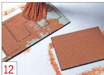
12 Schichtwechsel: Unterfütterungskarton wird mit Dispersionsspachtel und -farbe verputzt...
