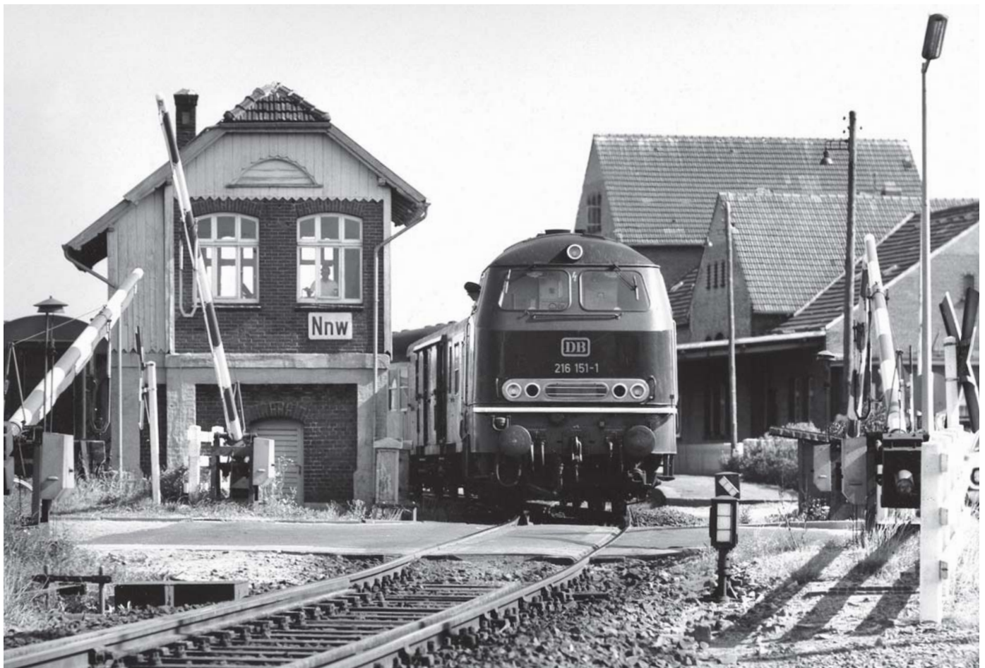
Der E585 aus Braunschweig wird im Bahnhof Norddeich rangiert. Vom Stellwerk aus werden die Schranken wieder hochgekurbelt.
