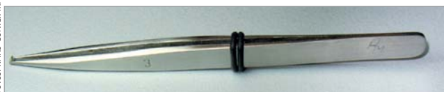
Die voreingestellte Pinzette mit der Gummiring-Fixierung.
