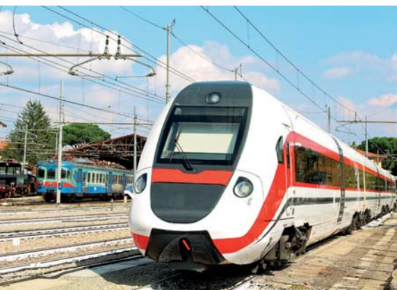
Das Neigesystem SIBI der spanischen CAF arbeitet mit gespeicherten Streckendaten und GPS-Verortung. Der ATR 365 für Sardinien unternimmt seit zwei Jahren Tests in der Toskana, die Typenzulassung steht noch aus.
