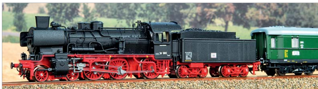
Markantes Merkmal der Lokvariante ist der Giesl-Flachschorstein, wie er bei der 38.10. verwendet wurde.
