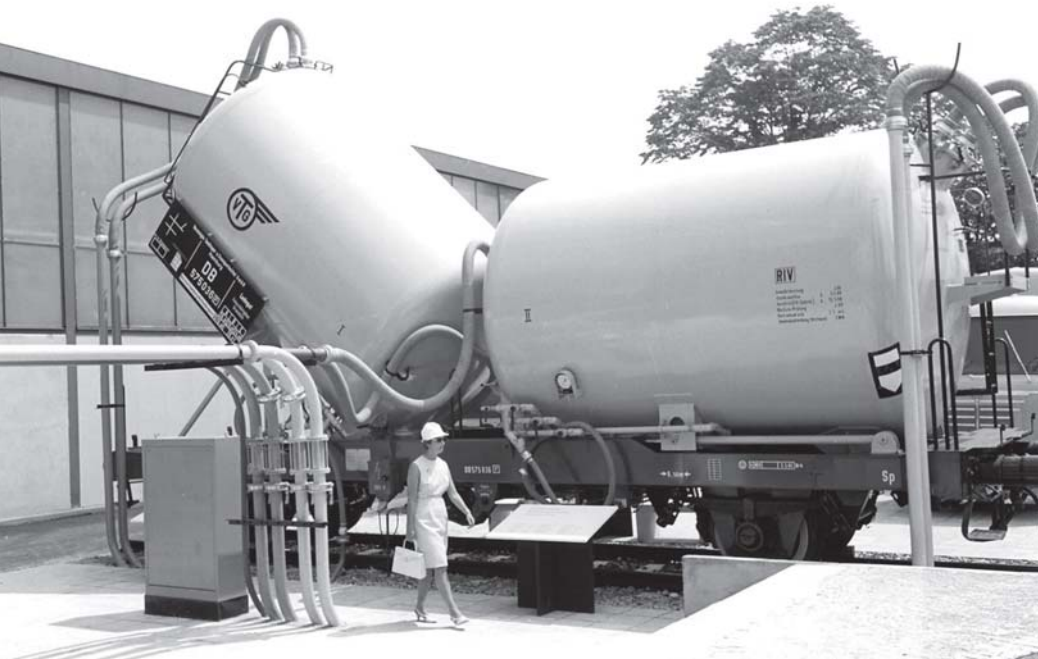
Für Feinschüttgüter und Granulate war dieser Spezialwagen konstruiert, den die Hamburger VTG samt Verladeeinrichtung in München ausstellte.
