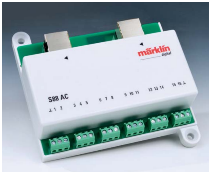
Der s88-AC wird von Märklin als Decoder bezeichnet, ist aber ein Rückmelde-Modul mit 16 Eingängen für das Mittelleiter-System.
