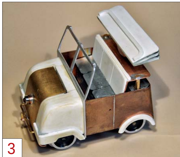
3 Anhand der unterschiedlichen Farben lässt sich der Materialmix aus Polystyrol, Messing, Kupfer und Aluminium gut erkennen.
