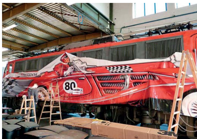
Eine Überraschung war 2010 der Antihaftgrund der für das Autozug-Motiv vorgesehenen Lok. Das Anbringen der Folien war unmöglich.
