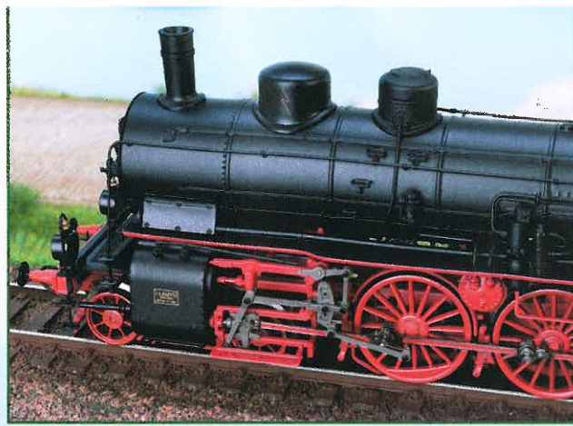
Eng ging es beim Vorbild wegen des Antriebs auf die erste Kuppelachse im Bereich der Steuerung zu.
