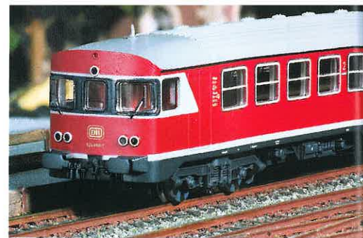
Die modernisierte Kopfform in der MAN-Bauform ohne Übergangstüren ist gut getroffen.
