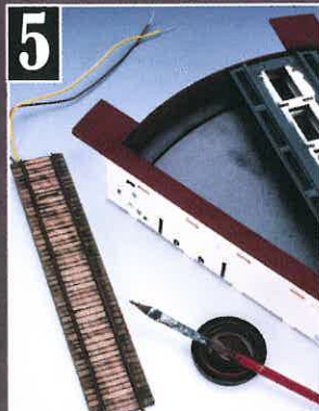
Eine individuelle Komplettbemalung aller später sichtbaren Kartonflächen sowie der Schienenprofile sorgt für ein perfektes Modell.
