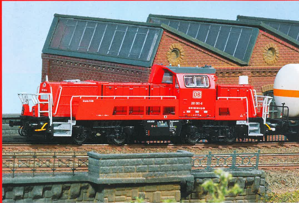
Die Gravita ist nach dem bewährten Konzept mit Mittelführerstand konstruiert, das auch dem 1:160-Lokführer des Brawa-Modells gute Sicht in beide Fahrtrichtungen bietet.
