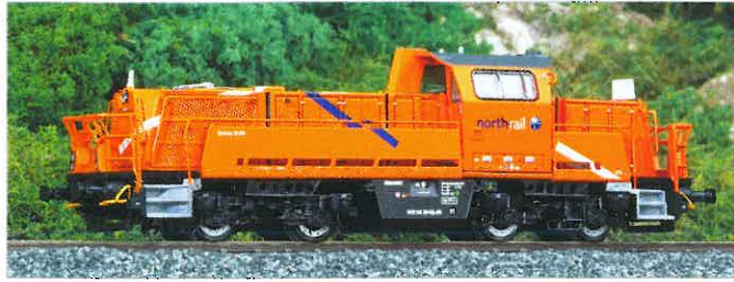
Gravita in der Baugröße N, mit Allachsantrieb und wahlweise mit Sound.
