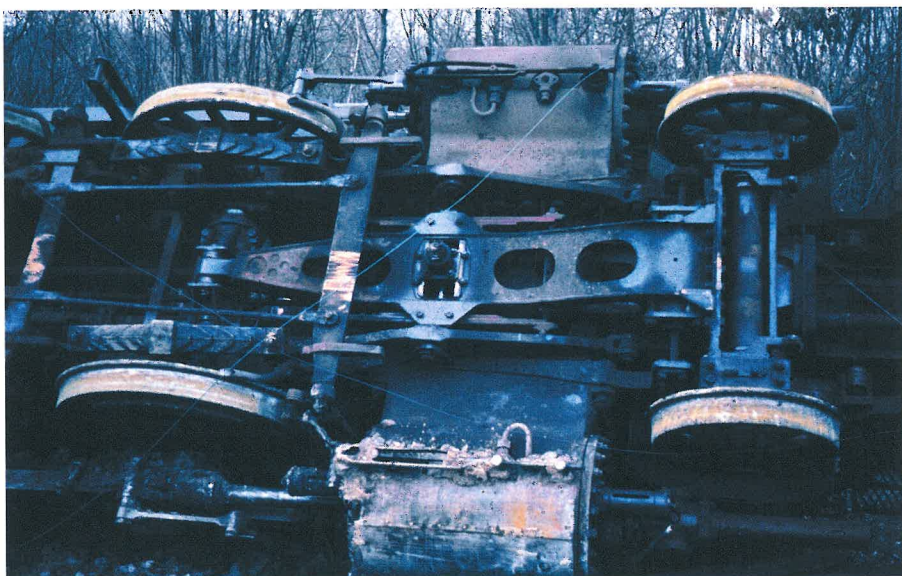
Seltene Vorbild-Untersicht: Die ungeteilte Aufmerksamkeit gilt in diesem Falle dem Krauß-Helmholtz-Gestell einer 50 mit Führungszapfen in der Mitte der Deichsel.
