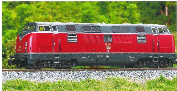
Fleischmanns 221 104 in N besitzt eine Digital-Schnittstelle.
