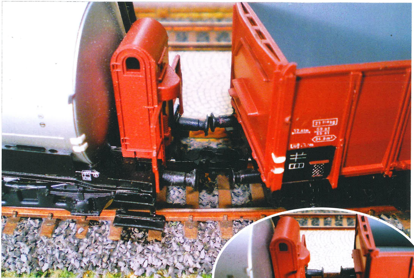
Vorher (kl. Bild r.) und nachher (Bild oben): Zwei alte Piko-Wagen, mit der typischen Bügelkupplung ausgerüstet, stehen nach dem Umbau selbst im Gleisbogen nahezu Puffer an Puffer.
