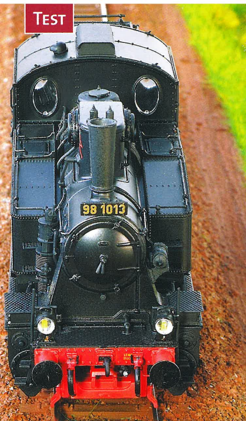
Charakteristisch für das Vorbild sind die großen ovalen Führerstandsfenster.
