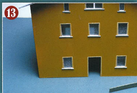
Gemäß dem Vorbild erfolgt nun das Anbringen des Steinsockelimitats, dessen erfreulich geringe Materialstärke die Anpassung erleichtert.
