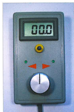
Handregler mit umschaltbarer Anzeige für Volt und Ampere.
